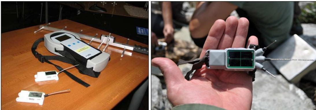
**Fotos 2 y 3.** Data-loggers GPS, estación base y antena de la empresa E-Obs (izquierda) y data-logger GPS (derecha; fotos: Javier de la Puente-SEO/BirdLife).
