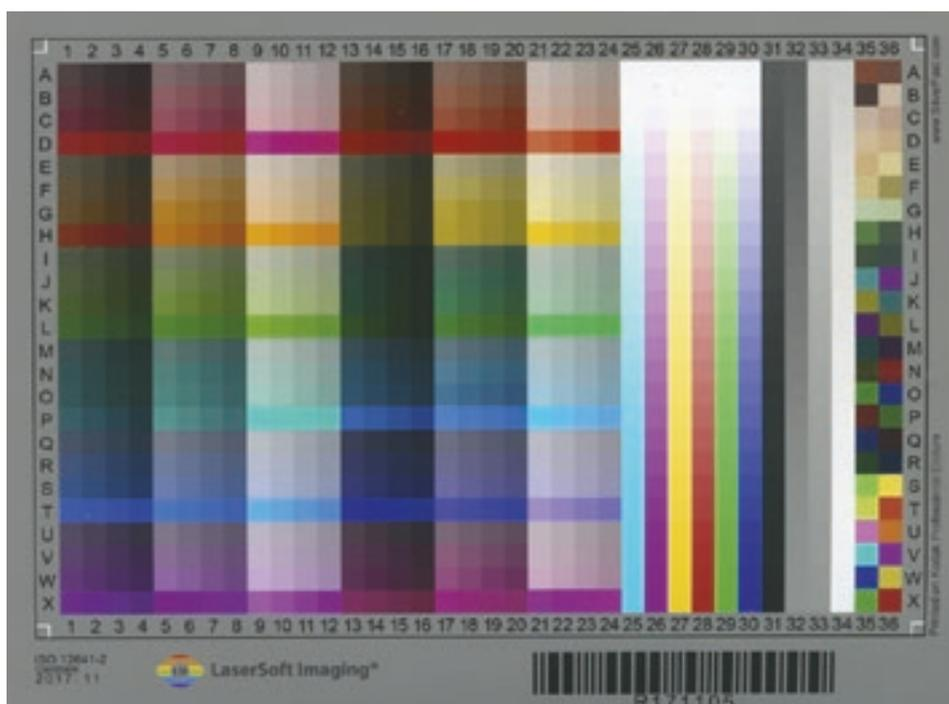
Ein IT8-Target, Farbmuster für die Kalibrierung von Scannern, Kameras etc. und das Erstellen von Farbprofilen ([www.silverfast.com](http://www.silverfast.com))
