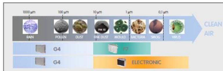
Efficienza della filtrazione elettrostatica rispetto alla filtrazione tradizionale
