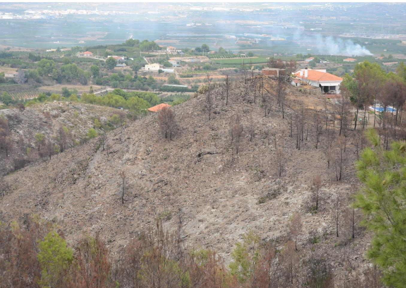
Imagen 7. Vivienda autoprotegida en el alto de un cerro. Ha resistido el impacto de un fuego. La discontinuidad existente con la masa forestal que la rodeaba, junto con una escasa vegetación en el jardín asegurando su mantenimiento más una elección adecuada de materiales de construcción resistentes apunta ser la receta incluso para ubicaciones desfavorables de viviendas. Fuente: MEDI XXI.
