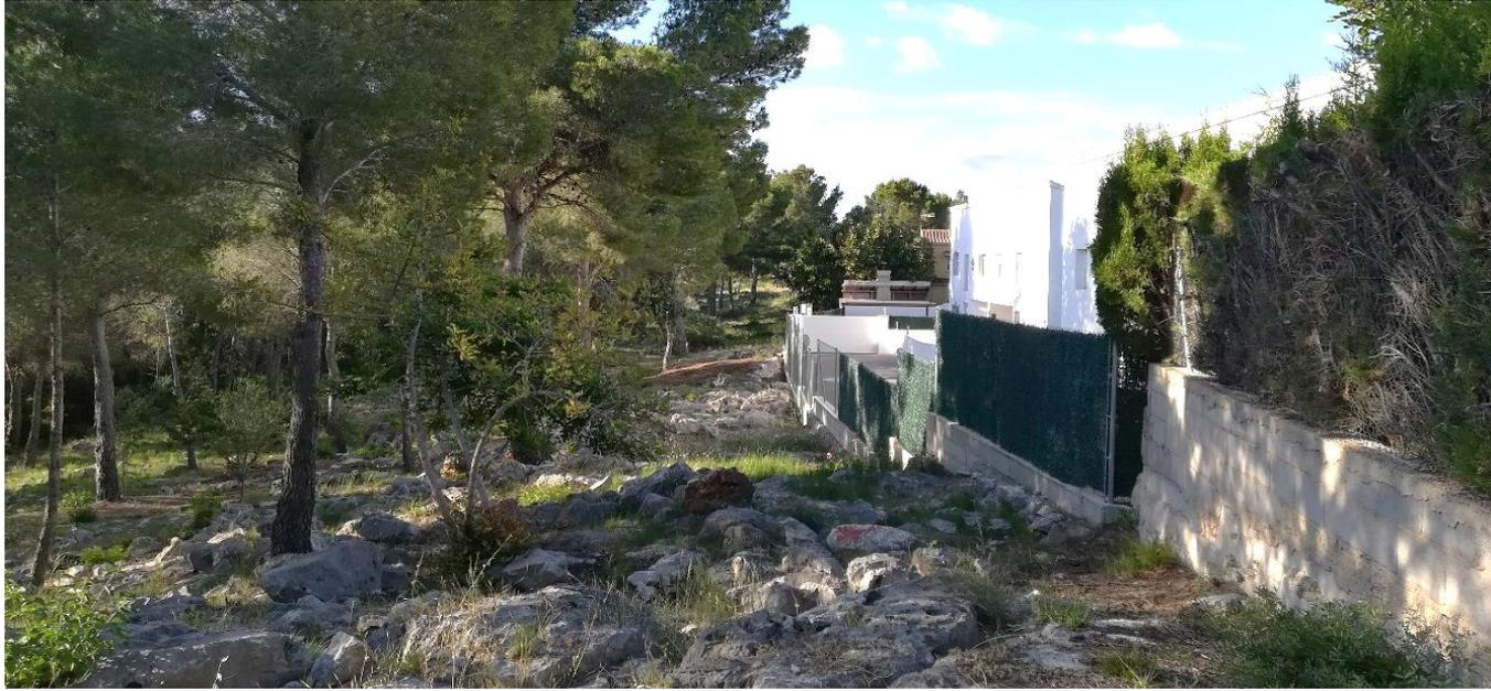
Imagen 67. Se observa una franja perimetral dimensionada y ejecutada insuficientemente, junto con la combinación de; inmediatez de la masa forestal y combinación de dos tipos de vallado parcelario muy inflamables, por un lado, el vegetal parcial de ciprés y por el otro, malla de plástico de ocultación. Fuente: MEDI XXI.
