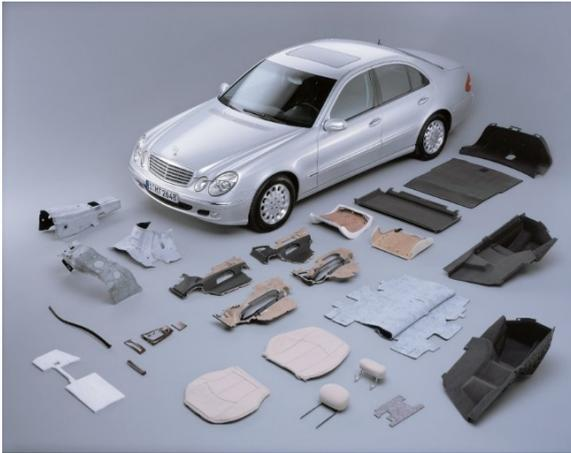
**Abbildung 13. Einige Komponenten im Fahrzeuginnenbereich aus Naturfaserverbundwerkstoffen für die Automobilindustrie.**
