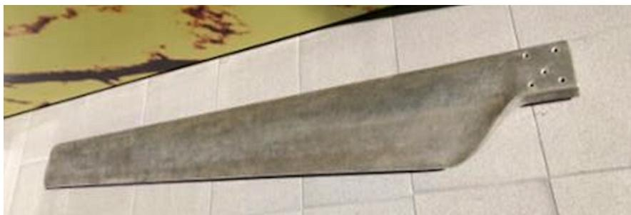
**Abbildung 15. Rotorblatt für Kleinwindkraftwerk aus Hanfgewebe vom Kompetenzzentrum Holz.**
