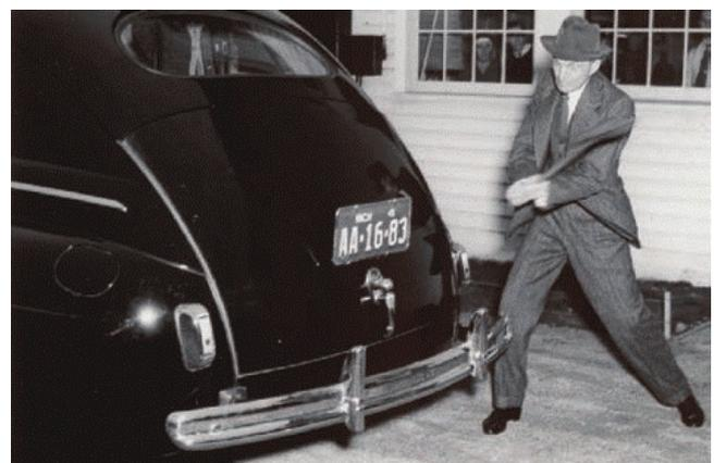
**Abbildung 12. Henry Ford und sein "Hanfauto".** Der Rahmen bestand aus Verbundmaterial auf Hanffaserbasis; Die Stärke dieses Materials wurde von Ford selbst demonstriert, indem er auf die Karosserie mit einem Hammer schlug.
