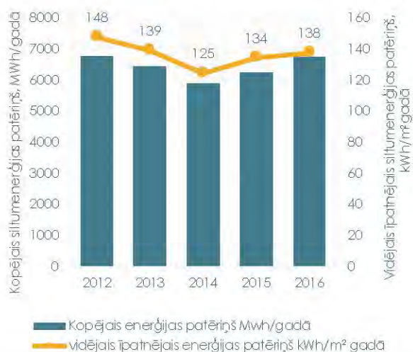
2.18.ATTĒLS: Kopējais un īpatnējais siltumenerģijas patēriņš pašvaldību ēkās, kas pieslēgtas Dobeles CSS
