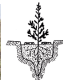
Σχήμα 6. Βαθιά φύτευση δενδρυλλίου σε λάκκο με λαγκίσκο (πηγή : Χατζησταθής Α. & Ντάφης Σ., 1989)
