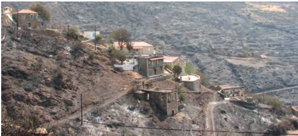
Εικόνα 3: Δασική πυρκαγιά έχει προκαλέσει σοβαρές ζημιές σ' έναν ορεινό οικισμό, εντός και περιμετρικά του οποίου δεν είχε γίνει έγκαιρα, η απαραίτητη απομάκρυνση και αραίωση των λεπτών δασικών καυσίμων (χόρτων) από τους κατοίκους. Οι κάτοικοι του οικισμού είναι λίγοι και μεγάλης ηλικίας και ο οικισμός θεωρείται απομονωμένος.
