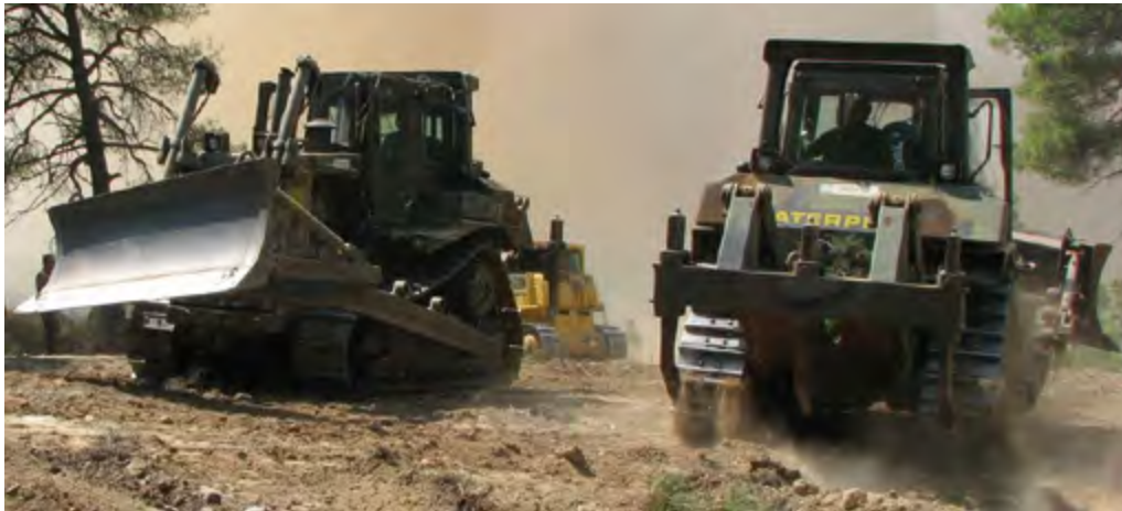
Εικόνα 12: Τρεις προωθητές γαιών εργάζονται ταυτόχρονα, διανοίγοντας αντιπυρική ζώνη κατά τις προσπάθειες οριοθέτησης και καταστολής δασικής πυρκαγιάς.
