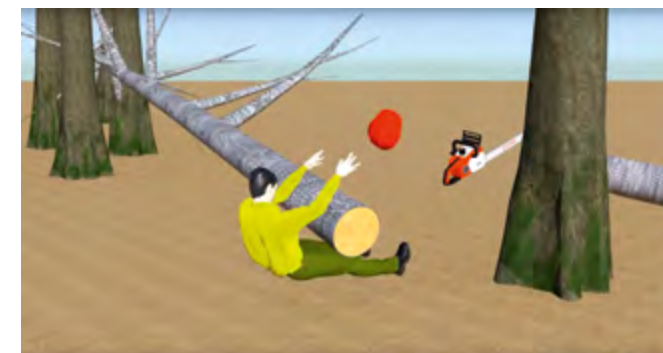
Εικόνα 3δ: Οι τάσεις που έχουν συσσωρευθεί και παρουσιάζονται στην εικόνα, εξηγούν το γιατί ο κορμός τινάχτηκε προς τον χειριστή του αλυσοπρίονου, κατά την ολοκλήρωση της κοπής.
