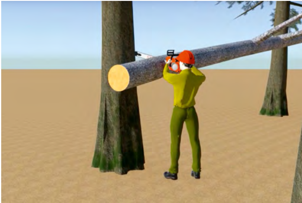
Εικόνα 3α: Ο χειριστής του αλυσοπρίονου εκτελεί το αρχικό κόψιμο από την επάνω πλευρά, βρισκόμενος στην πλευρά που βρίσκεται και ο κορμός.
