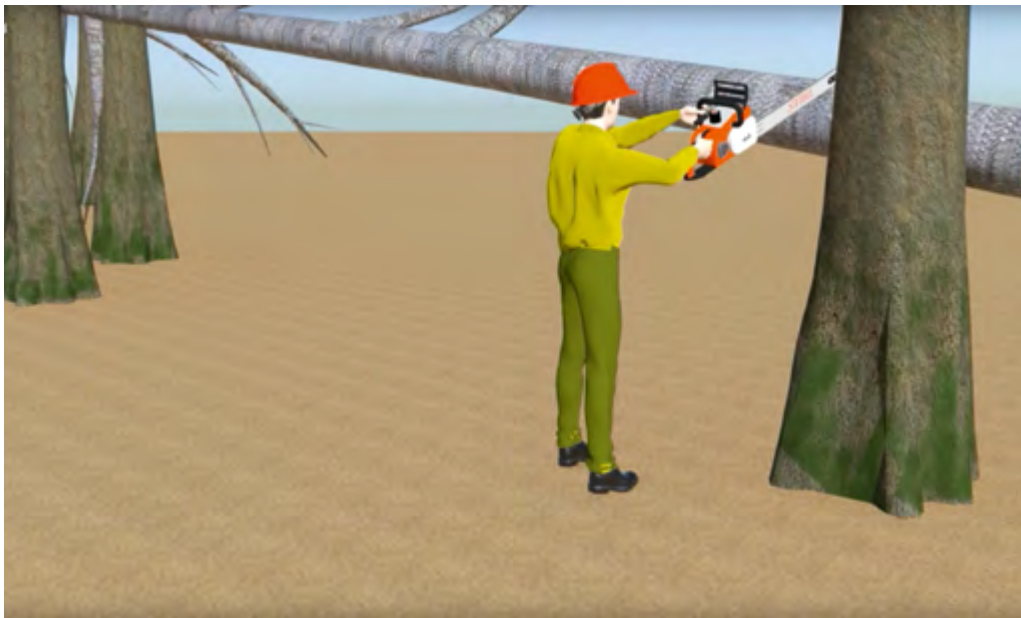
Εικόνα 3β: Έχοντας κόψει και από την κάτω πλευρά, ενόσω βρισκόταν στην πλευρά που βρίσκεται και ο κορμός, ο χειριστής του αλυσοπρίονου συνεχίζει για να ολοκληρώσει το κόψιμο, κόβοντας από την επάνω πλευρά και βρισκόμενος τώρα στην άλλη πλευρά από εκείνη που βρίσκεται ο κορμός.
