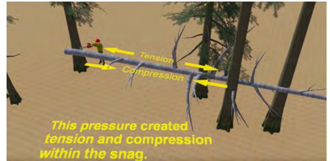
Εικόνα 3δ: Οι τάσεις που έχουν συσσωρευθεί και παρουσιάζονται στην εικόνα, εξηγούν το γιατί ο κορμός τινάχτηκε προς τον χειριστή του αλυσοπρίονου, κατά την ολοκλήρωση της κοπής.
