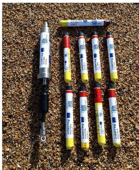
Figure 9: capteurs de pression et courantomètre utilisés sur la Grande Plage de Biarritz. Crédit : M.Delpey
