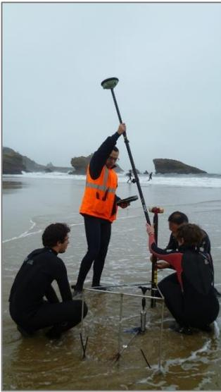
Figure 12: levés au DGPS de la position des capteurs et du profil de plage
