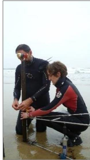
Figure 13 : installation du courantomètre et d'un capteur de pression
