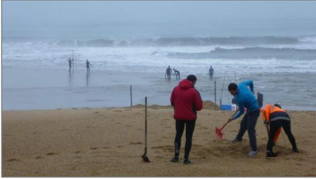
Figure 10: installation des poteaux servant à fixer les capteurs
