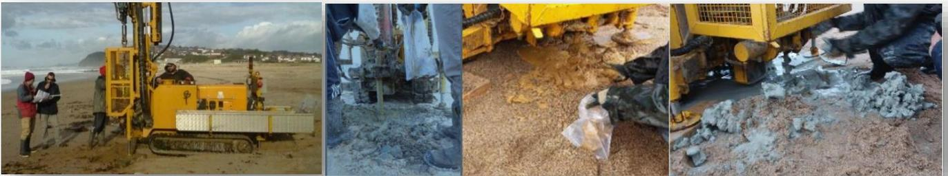
Figure 17 : campagnes de sondages géologiques et échantillonnage de sédiments. Source : BRGM
