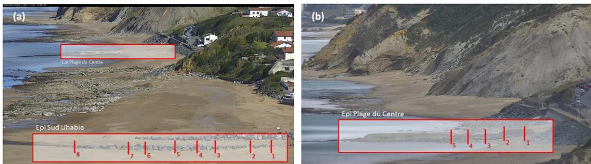
Figure 30. Localisation des profils de suivi au niveau de l'épi Sud de l'Uhabia (a) et de l'épi de la plage du Centre (b).
