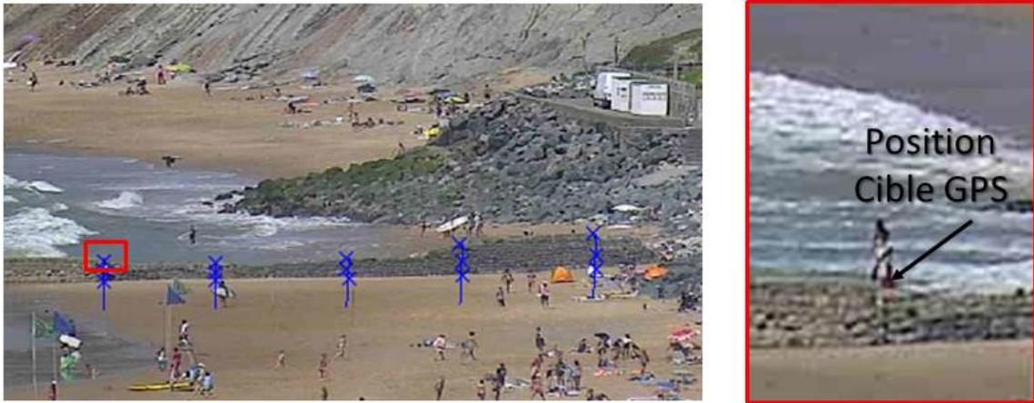
Figure 35. Exemple des résultats de digitalisation de cible GPS au niveau de l'épi de la Centrale (a), et (b) zoom sur la digitalisation d'un point GPS sur le profil 5.
