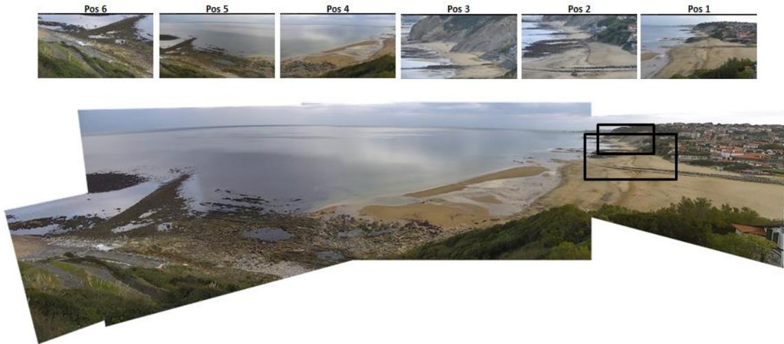
Figure 26. Champs de vision du système vidéo utilisé pour réaliser le suivi des plages de Bidart.
