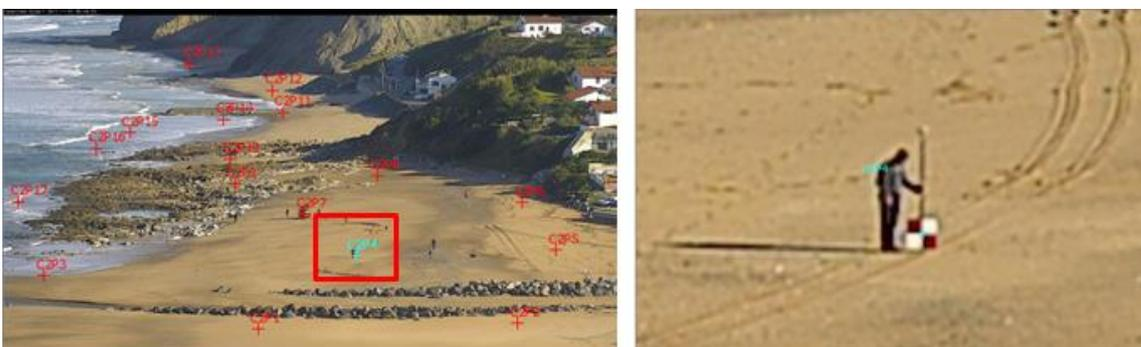
Figure 28: Mesures des points d'amer au DGPS centimétrique permettant le calcul des paramètres extrinsèques.
