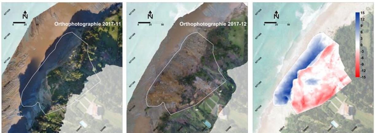
Figure 6. Mesure du volume de l'éboulement 1 à partir des deux levés photogrammétriques par drone : orthophoto de Novembre 2017 (a) et Décembre 2017 (b), et carte des différences altimétriques (c).
