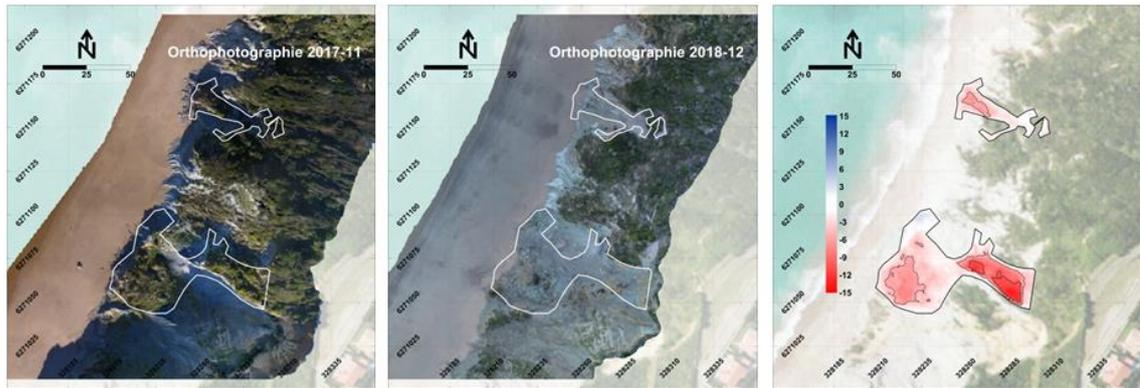
Figure 7. Mesure du volume de l'éboulement 2 à partir des deux levés photogrammétriques par drone : orthophoto de Novembre 2017 (a) et Décembre 2018 (b), et carte des différences altimétriques (c).
