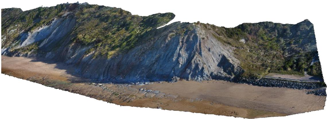
Figure 2 : Exemple de résultat de fin de traitement informatique : nuage de points colorisé.
