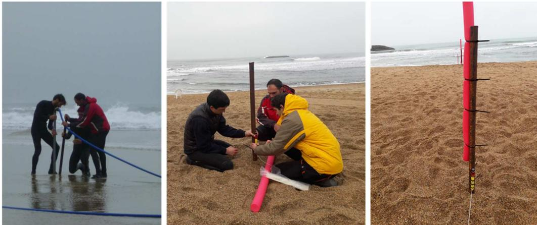
**Figure 4 : Photographies prises durant le déploiement MAREA 2018. Gauche : forage pour les perches de fixation. Centre : installation d'un capteur sur la perche. Droite : installation finalisée.**
