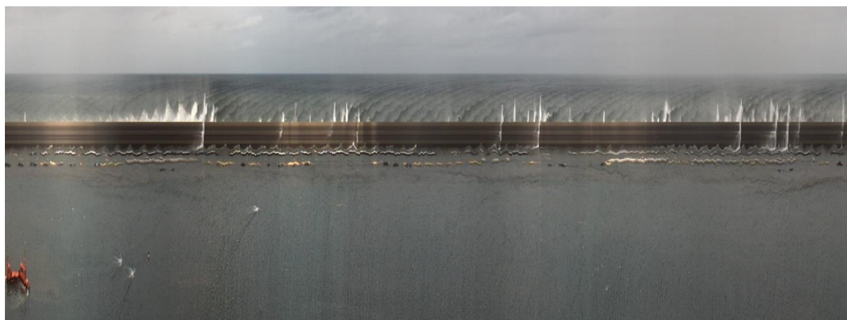
Imagen TIMESTACK para el seguimiento del rebase en el dique de abrigo
