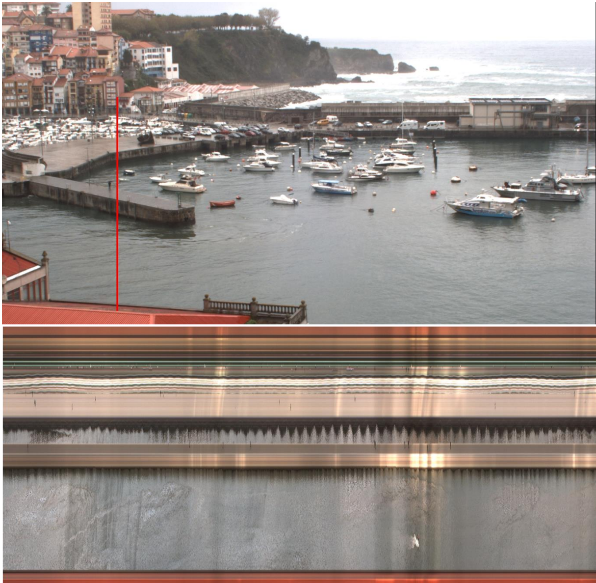
Transecto definido en la cámara 2 (línea roja) e imagen TIMESTACK resultante obtenida en la que se aprecian tanto los pulsos de corrientes de la bocana (en la parte inferior), la agitación del oleaje (en la zona central) y las oscilaciones infragravitatorias de mayor periodo en la dársena interior (parte superior de la imagen)
