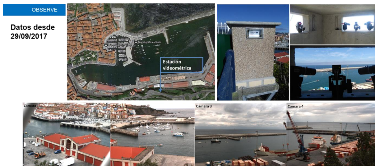
Ubicación y vistas de las 4 cámaras del sistema de videometría del puerto de Bermeo
