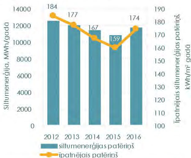
2.12.ATTĒLS: Kopējais un īpatnējais siltumenerģijas patēriņš dzīvojamā fonda ēkās 2012.-2016.gadā
