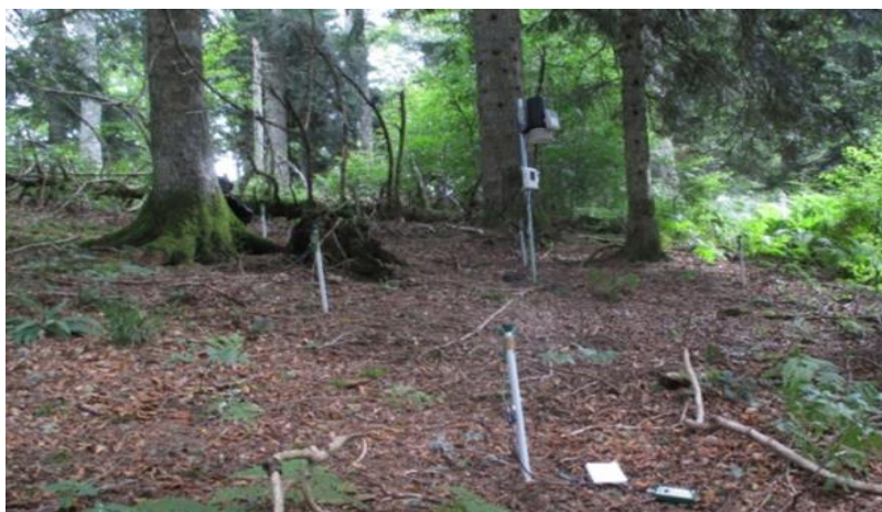
Foto: seis tensiómetros instalados debajo de un bosque denso (área basal de 50 m 2 / ha). Estos tensiómetros están vinculados aquí a una estación meteorológica que lee automáticamente los datos.
