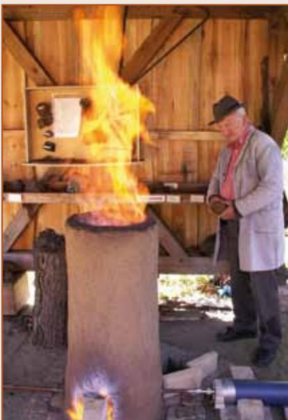
Abb. 34: Im Museum Sagar wird in einem nachgebauten Rennofen Eisen geschmolzen
