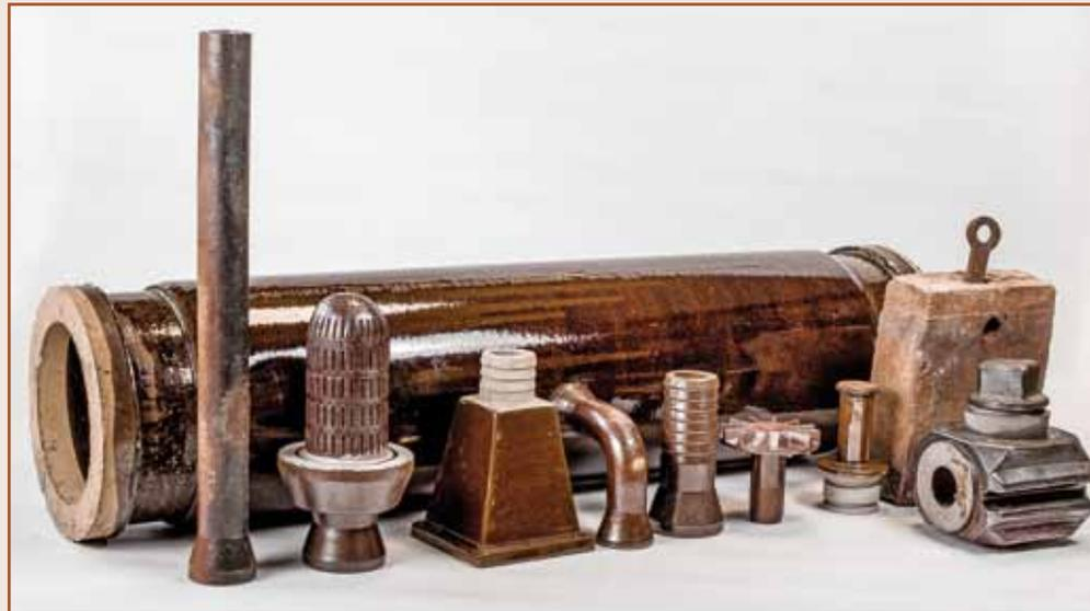
Abb. 47: Industriekeramische Erzeugnisse aus den Deutschen Ton- und Steinzeugwerken in Krauschwitz: verschiedene Tonrohre, ein Einfüllstutzen, ein Flügelrad und ein Schieber
