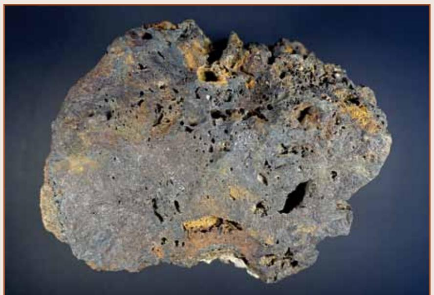
Abb. 35: Ein Stück Rennofenschlacke, das in der Turmruine von Trzebiel verbaut war. Breite des Stückes beträgt 16 cm. Später wurde das Eisen in der sogenannten Keula-Hütte geschmolzen. Für die dazu dringend notwendige Wasserversorgung wurde bei Weißwasser/O.L. der Braunsteich künstlich angelegt.
