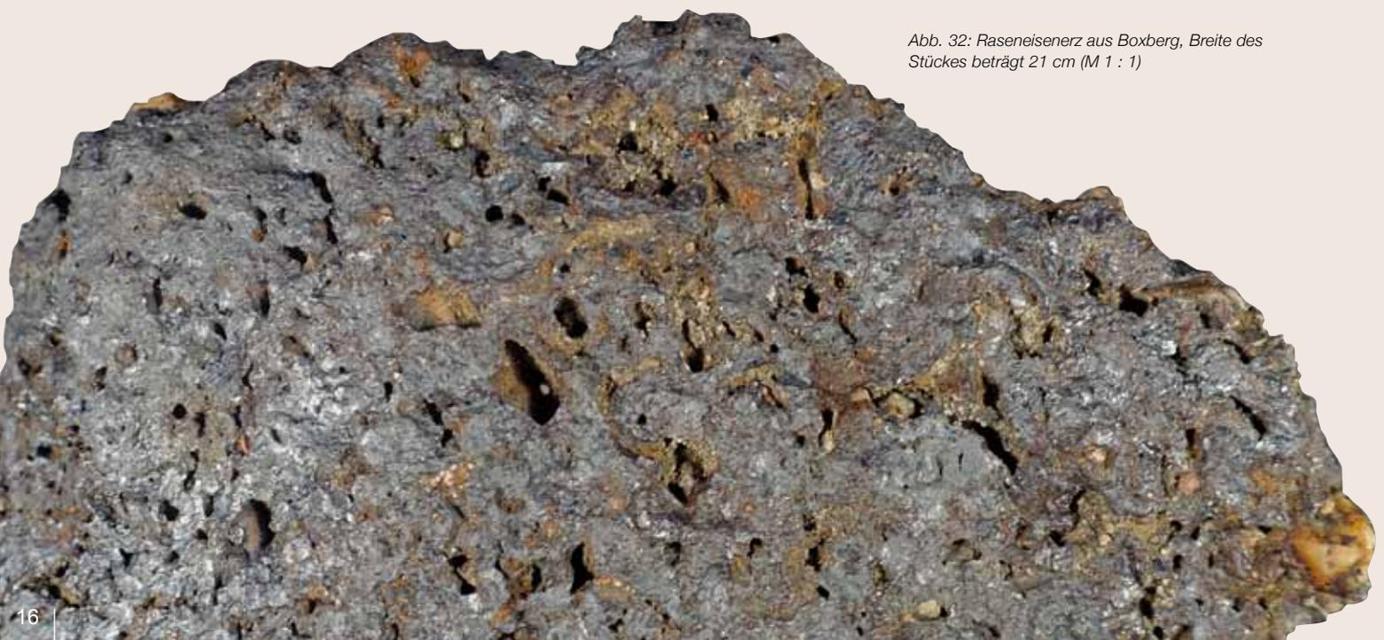
Abb. 32: Raseneisenerz aus Boxberg, Breite des Stückes beträgt 21 cm (M 1 : 1)
