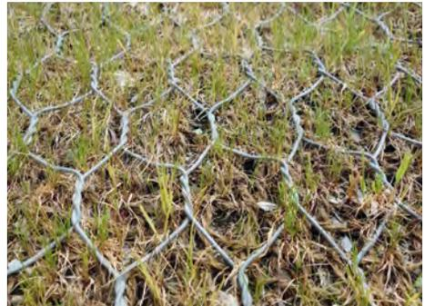
Fig. 62 – Fijación de una siembra con una malla de coco y una red metálica. La malla fija el suelo y las semillas. Ofrece mejores condiciones para el crecimiento de las plántulas.
