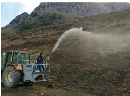
**Fig. 74a** – Siembra de 125 kg de una mezcla de 5 especies de la marca «Pyrégraine de néou»
