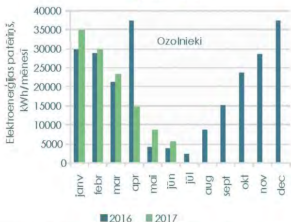
2.19.ATTĒLS: Elektroenerģijas patēriņš divos lielākajos apgaismojuma posmos pa mēnešiem 2016. un 2017.gadā
