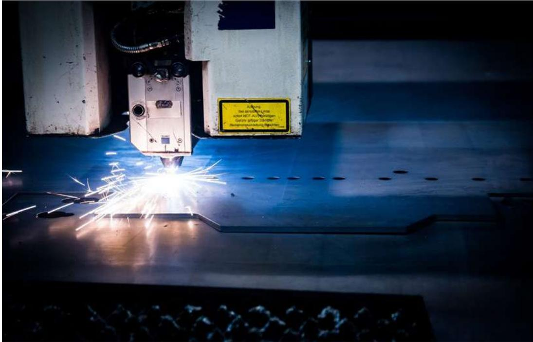
Konstruktionsmechaniker\*innen sind auf die Verarbeitung von Metall, Stahl und Aluminium spezialisiert. Sie fertigen z. B. Metallbaukonstruktionen, Industriemaschinen oder Schiffsbauteile an. Durch das sogenannte „thermische Schneiden“ können dafür einzelne Werkstücke maßgenau zugeschnitten werden. Dieses Verfahren kann mit Lasern durchgeführt werden.
