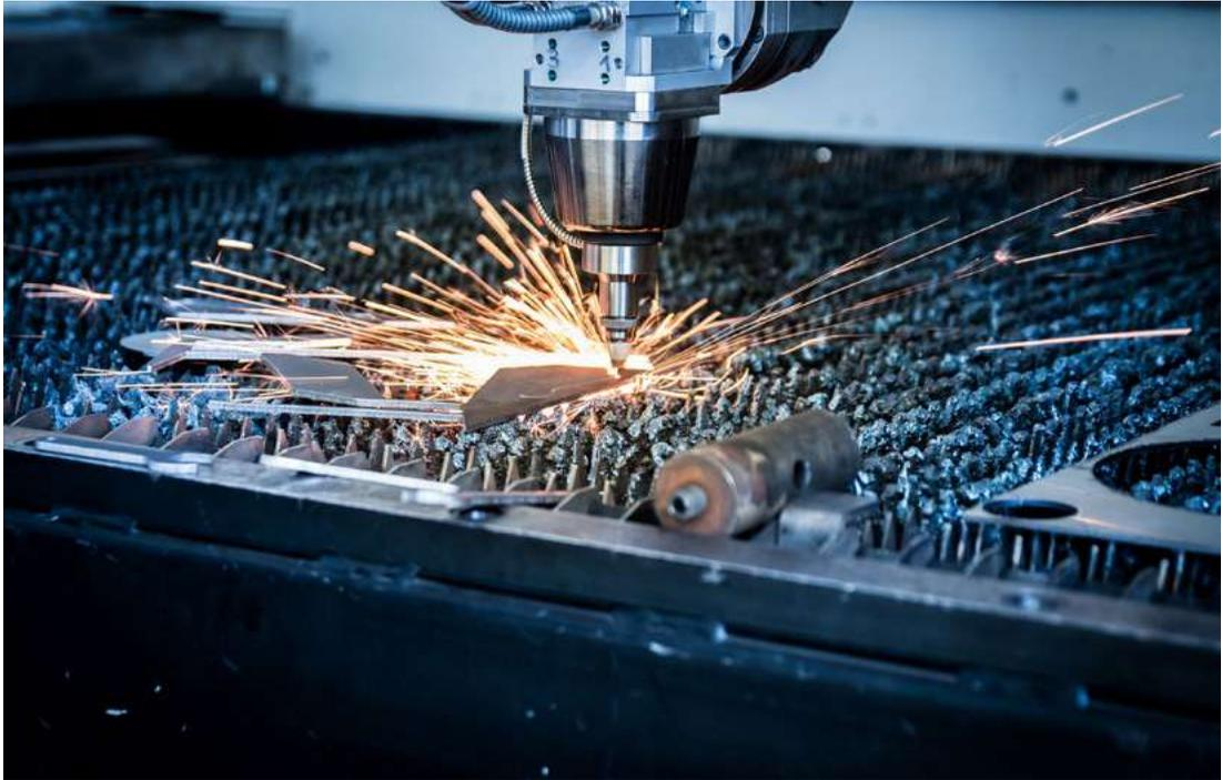
Bei der Verarbeitung von Metall, Stahl und Aluminium kommen sogenannte Kohlendioxid-Laser (kurz: CO<sub>2</sub>-Laser) zum Einsatz. Das von dem Laser ausgestrahlte Licht (umgangssprachlich Laserstrahl) trifft auf das Material und gibt dabei Energie ab. Das Material wird dadurch erhitzt und an dieser Stelle „geschnitten“. So können Zuschnitte auf den Mikrometer genau erreicht werden.
