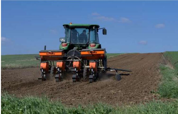
Damit die Aussaat auf einem Getreidefeld gut gelingt, müssen die Landwirt\*innen das Saatgut mit einer Sämaschine gleichmäßig in einer genauen Menge pro  $\text{m}^2$  aussäen. Als optimales Verhältnis hat sich dabei für Weizen 250 Saatkörner pro  $\text{m}^2$  herausgestellt.
