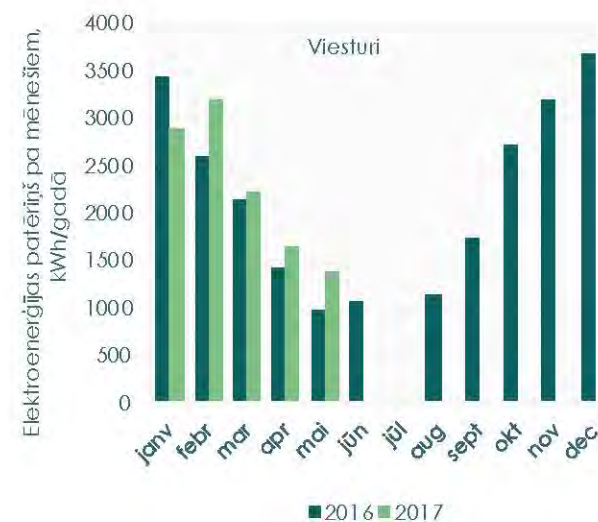
2.18.ATTĒLS: Elektroenerģijas patēriņš divos lielākajos apgaismojuma posmos pa mēnešiem 2016. un 2017.gadā
