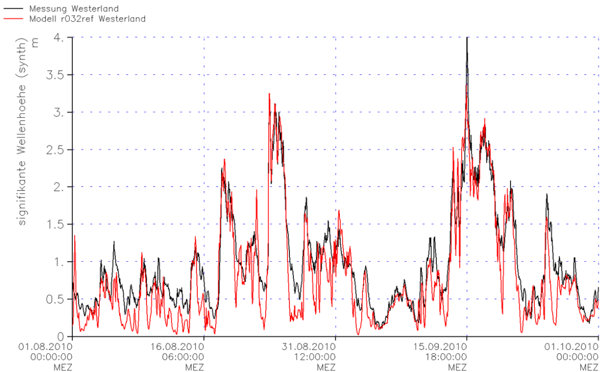
Bild 25: Signifikante Wellenhöhe für die Monate August und September 2010 am Pegel Westerland aus Messungen (schwarze Kurve) und aus Modellergebnissen (rote Kurve).
