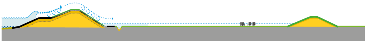
Bestaande dijk met achterlandkering
