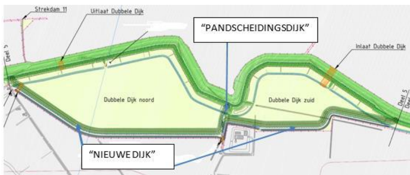
Figuur 2 Plattegrond demonstratieproject Dubbele Dijk bij de dijkverbetering Eemshaven-Delfzijl. De in het plaatje genoemde 'Nieuwe dijk' is de achterliggende kering, bron Ommelanderdiek (2019).
