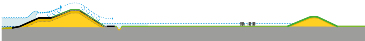
Figuur 3 Doorsnede Demonstratieproject Dubbele Dijk; Voorliggende kering, tussengebied en achterliggende kering.
