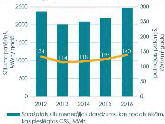
2.14. ATTĒLS: Kopējais un īpatnējais siltumenerģijas patēriņš CSS pieslēgtajās ēkās Salas novadā, 2012. – 2016. gadā (* īpatnējais siltumenerģijas patēriņš ēkās balstīts uz saražotās siltumenerģijas datiem (pašvaldības un "EM ENERGO" saražotā enerģija) patērētājiem nodotās siltumenerģijas datu trūkuma dēļ)
