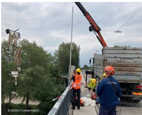
Meranie transportu plastov pomocou záchytných sietí na prístavnom moste Freudenau
