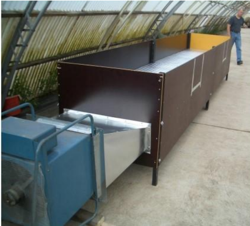
Kuva 3. Filmivanerista ja suomulevystä koottu lavakuivuri. Kuva: Markku Koistinen, RAMK Kätehanke.
