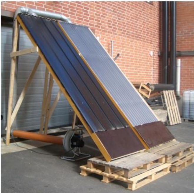
Kuva 10. Aurinkokeräimet sisään puhallettavan ilman lämmityksessä. Kuva: Markku Koistinen, RAMK Katehanke.
