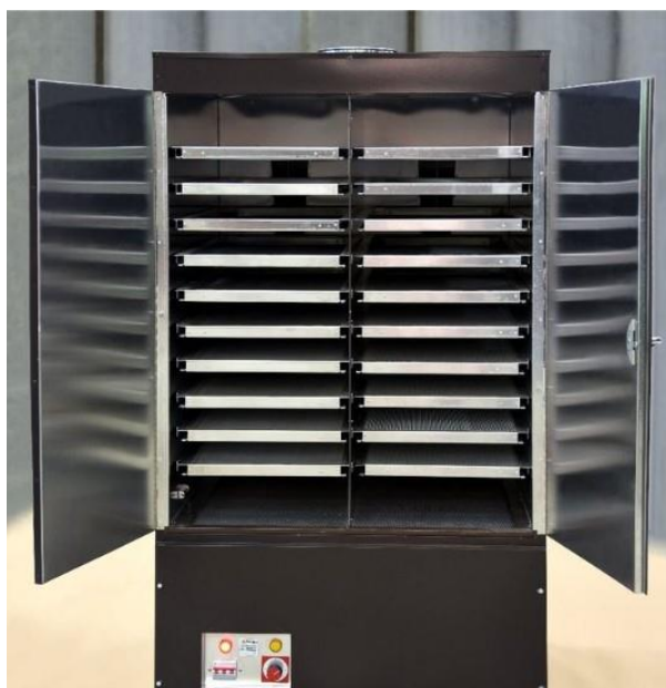
Kuva 8. Orakas Tuotteet Oy:n Iso Orakas, jossa lämmin ilma puhalletaan alhaalta ylös hyllyjen läpi. 6 kW lämpöteho ja kuivauspinta-ala noin 6 m 2 . Kuva: Orakas Tuotteet Oy.
