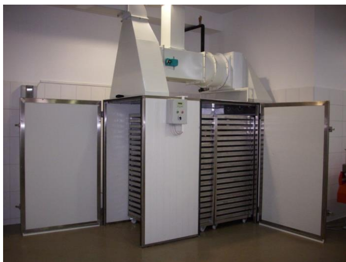
Kuva 7. Kroatialaisen Herbas d.o.o.:n rullakkokuivuri, jossa tuotteet asetetaan rullakoiden hyllyille. Lämpimän ilman puhallus sivulta. Poistoilman kierrätys takaisin kuivuriin käynnistyy, kun poistoilman suhteellinen kosteus on laskenut riittävän alas. Kuva: Herbas d.o.o.
