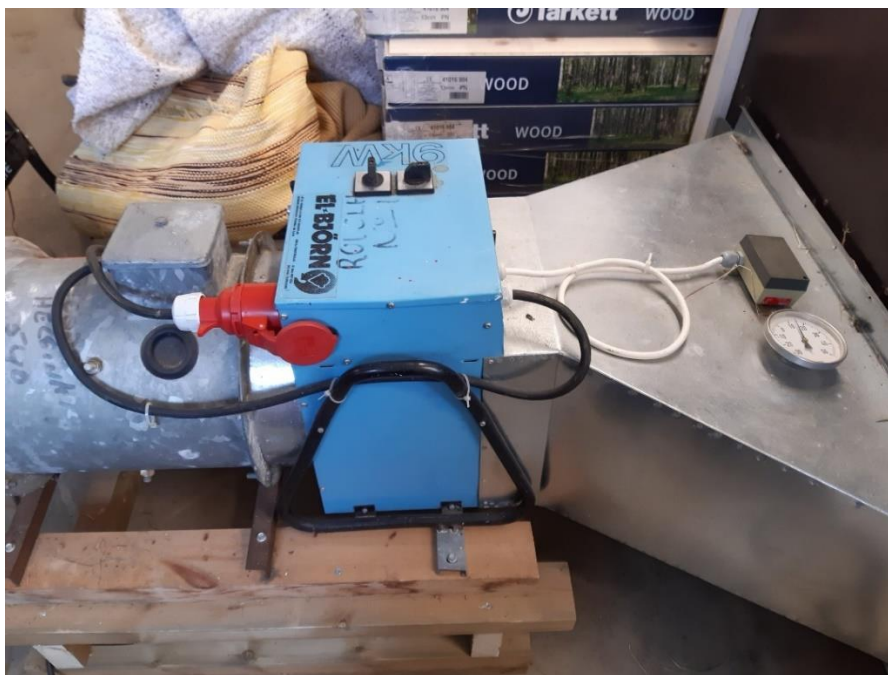
Kuva 4. Puhallin, 9 kW:n rakennuslämmitin ja muuntoyhde, jossa lämpötila-anturi lavakuivurin edessä. Kuva: Jaana Väisänen.
