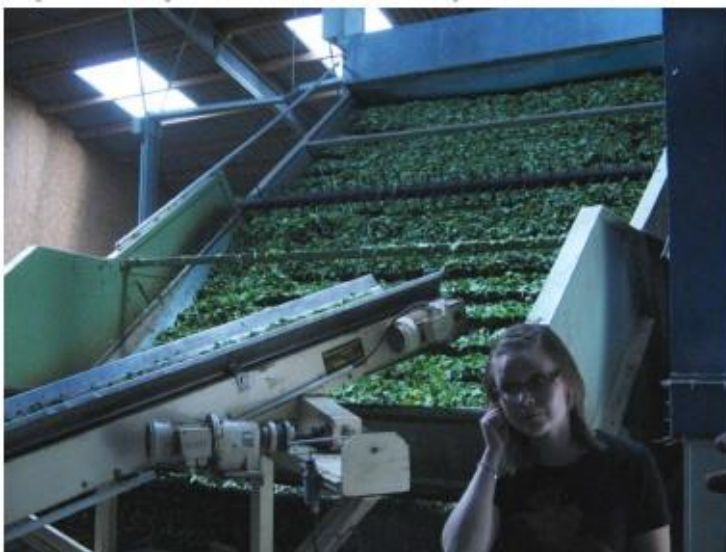
Kuva 6. Krassia syöttökuljettimessa nousemassa hihnakuivuriin, yrttitala Ochs Baijerissa. Kuva: Jaana Väisänen
