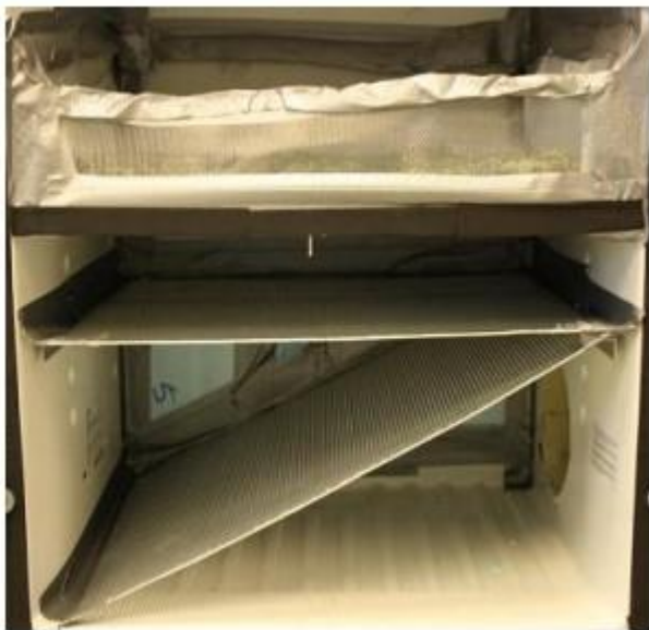
Kuva 17. Viisto reikäpelti jääkaappikuivurissa ilmavirtaa tasaamassa.
