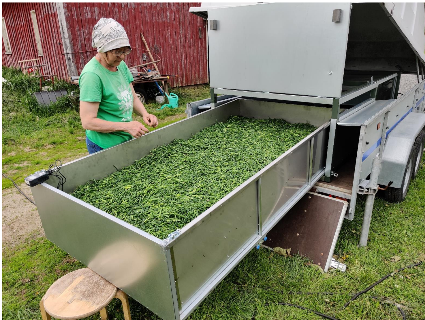
Kuva 9. Peräkärrikuivurin täyttöö ruohosipulilla. Kuivauslaatikko voidaan täyttää laatikon yläreunaan asti.
