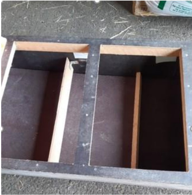
Kuva 12. Turvekuivurin ilmakanaaliin rakennettiin sokkeloa parantamaan ilmavirran tasaisuutta. Etuosassa on kaksi estettä, joista ensimmäinen pohjalevyssä kiinni ja toinen 2-3 sentin korkeudella pohjalevystä.
