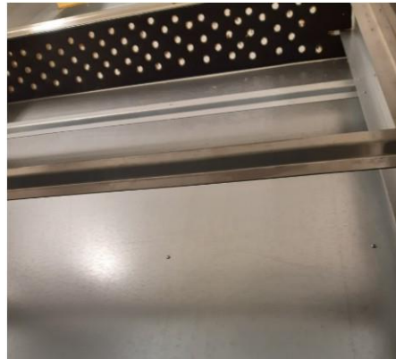
Kuvat 13 ja 14. Lavakuivurin peräosaan pystyyn sijoitettu reikälevy (tässä filmivaneria) vähensi peräosan ilmamäärää ja tasasi etuosan ilmannopeuksia.
