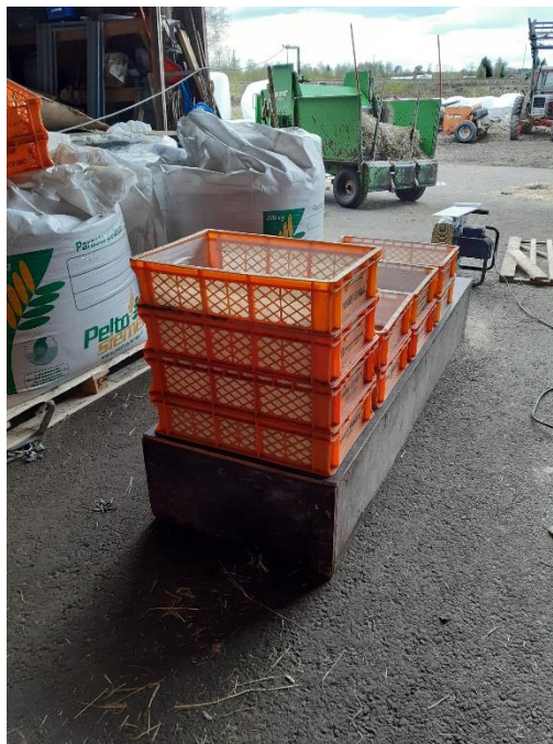
Kuva 7. Leipomolaatikkokuivurin ilmannopeuksia tutkittiin asettamalla tasapaksut vanulevyt leipomolaatikoiden ritalöiden päälle ja mittaamalla ilmavirtaa vanun päältä.
