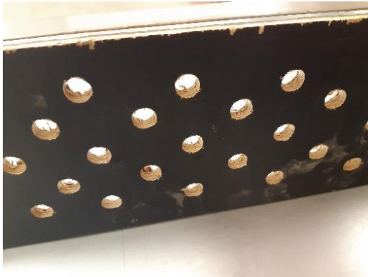
Kuvat 13 ja 14. Lavakuivurin peräosaan pystyyn sijoitettu reikälevy (tässä filmivaneria) vähensi peräosan ilmamäärää ja tasasi etuosan ilmannopeuksia.
