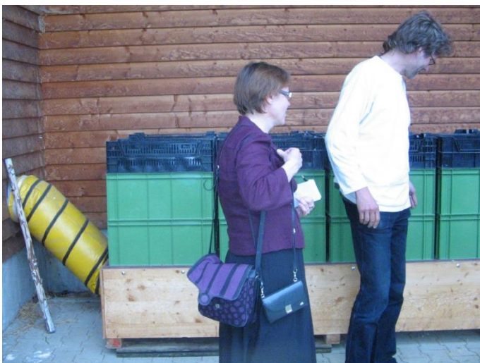
Kuvat 5 ja 6. Walan tehtaan pieni laatikkokuivuri yrityksen omistamalla maatilalla. Kuivuri hyödyntää maatilalan lämpökeskuksen lämpöä. Kuivumassa kehäkukkaa. Kuvat Petri Leinonen.
