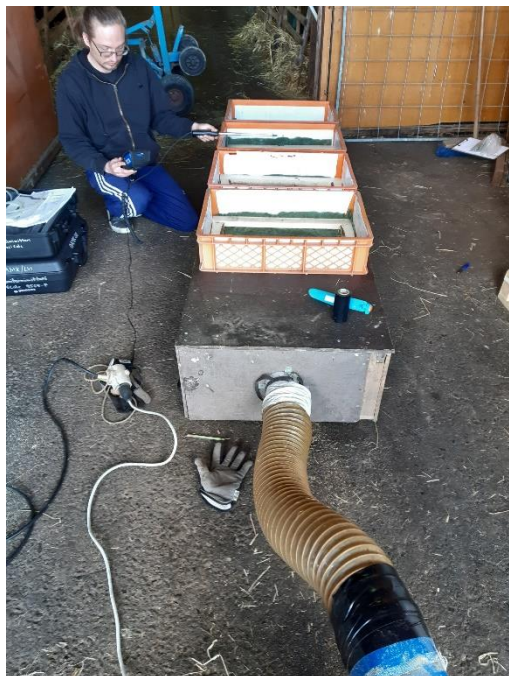
Kuva 7. Leipomolaatikkokuivurin ilmannopeuksia tutkittiin asettamalla tasapaksut vanulevyt leipomolaatikoiden ritalöiden päälle ja mittaamalla ilmavirtaa vanun päältä.
