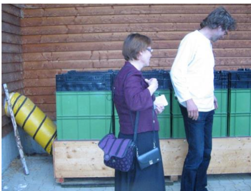
Fig. 5 och 6. Lådtorken på Wala-fabrikens gård i Tyskland. Torken utnyttjar värme från pannrummet. I torken ringblommor. Fotos Petri Leinonen.
