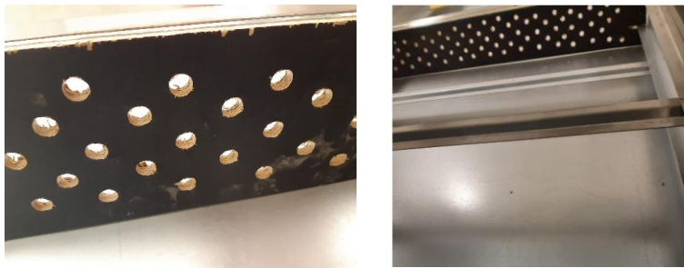
Fig. 13 ja 14. Vertikalt placerad perforerad skiva (här faner) i kanalens bakdel förminskade lufthastigheten framför bakväggen och utjämnade lufthastigheter i främre delen.
