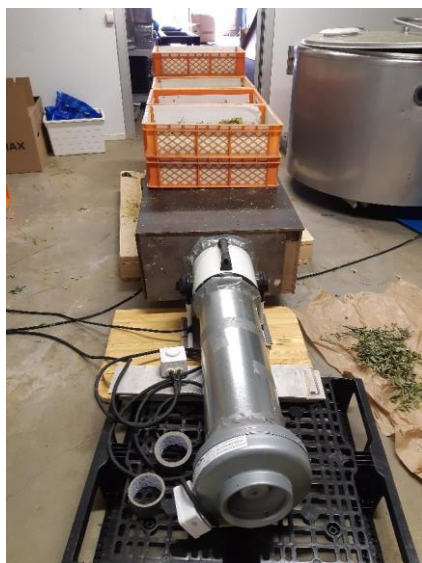
Fig. 16. Torvtorken lånades till torkning av älgörten. Samtidigt byttes den övereffektiva fläkten mot en 60 watt kanalfläkt, som kopplades ihop med en byggvärmare 1,5 kW. Denna kombination och styrplattor i luftkanalen gav ganska enhetligt luftflöde både till främre och bakdelen av torken. Mellan kanalfläkten och byggvärmaren hittade vi ett lämpligt plåtrör. Luftflödet styrdes med tyristor utrustad med en glidkoppling.
