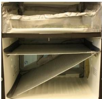
Fig. 17. Den perforerade plåtskivan i skåptorken utjämnade luftflödet.
