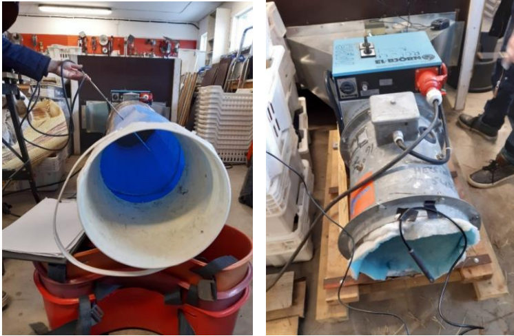
Fig. 1. Mätning av lufthastigheter med pitot-rör. För mätningen byggde vi ett runt luftkanal av plastskivor framför fläktens luftintag. Dess form stöttes med en gammal potatishink. All material hittar sin plats!
