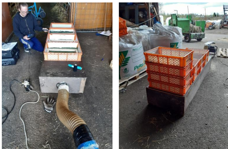
Fig. 7. Torken byggd av bagerilådor studerades genom att sätta enhetliga vaddark på lådornas botten. Luftflödehastigheten mätades ovan på arken.
