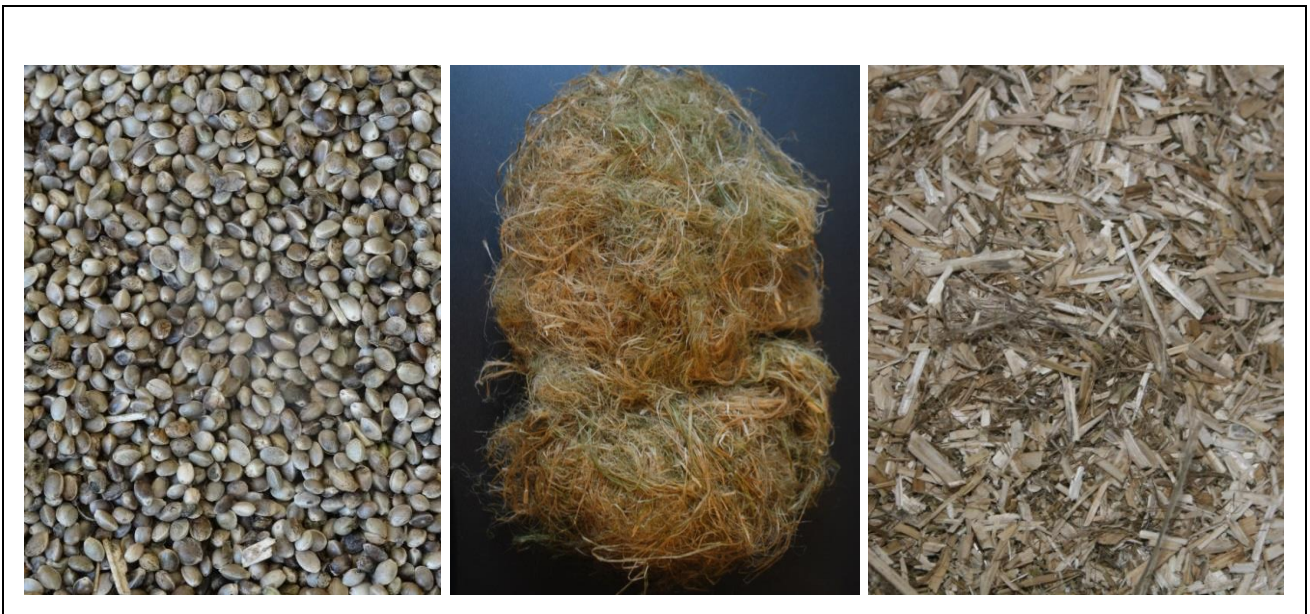
Figuur 8: Drie eindproducten na primaire verwerking: zaad, totaal vezel en scheven (Eigen beeldmateriaal, 2014)
