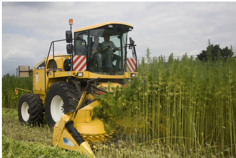
Figuur 3: Oogstmachine voor het stro - aangepaste maïshakselaar met kemperbek van Belchanvre (Eigen beeldmateriaal, 2014)
