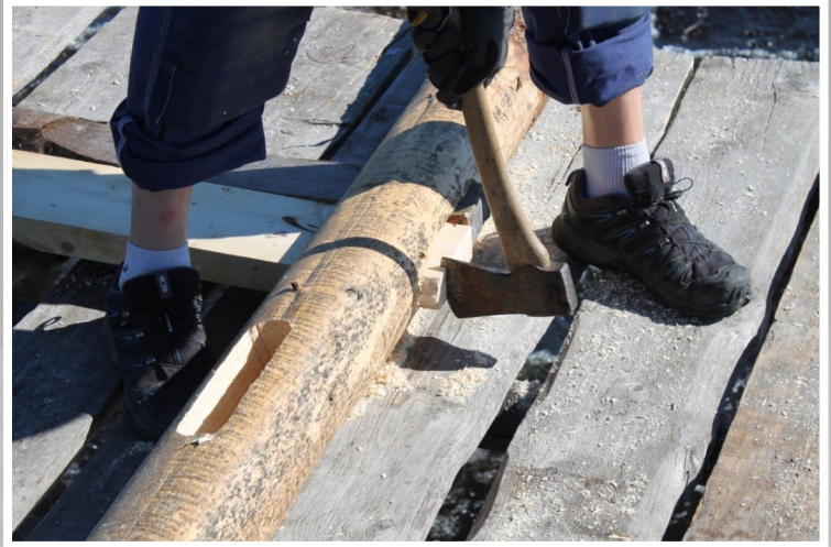
Kuva: Pienelle kiilalle tehdään aloitusviihto kirveellä (JN).
