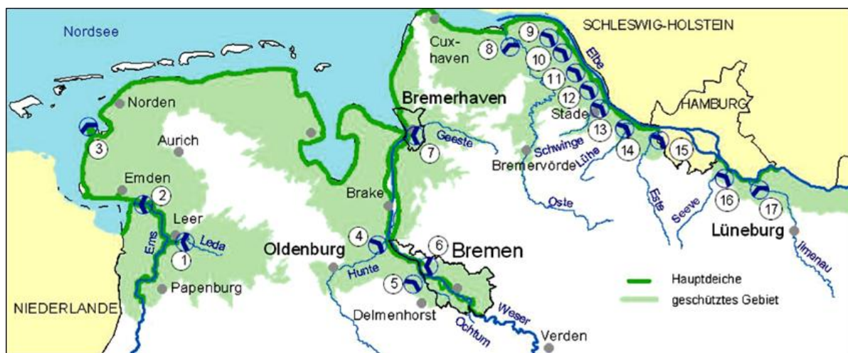
(1) Leda-Sperrwerk (2) Emssperrwerk (3) Sperrwerk Leysiel (4) Hunte-Sperrwerk (5) Ochtum-Sperrwerk (6) Lesum-Sperrwerk (7) Geeste Sturmflutsperrwerk (8) Ostesperrwerk (9) Sperrwerk Freiburg (10) Sperrwerk Wischhafen (11) Sperrwerk Ruthenstrom (12) Sperrwerk Abbenfleth (13) Schwinge-Sperrwerk (14) Lühe-Sperrwerk (15) Este-Sperrwerk (16) Sperrwerk Seesiel (17) Ilmenau-Sperrwerk
