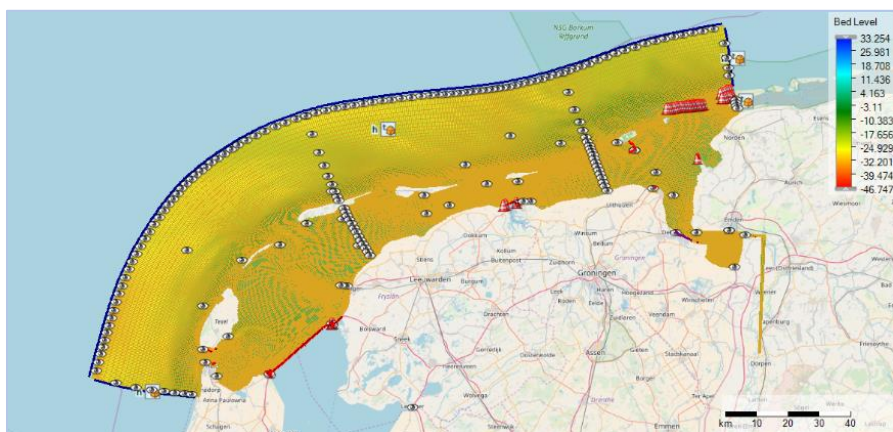
Figuur 9, In het hydromorfologisch modelonderzoek gebruikt HKV 15 het D-Flow FM model
