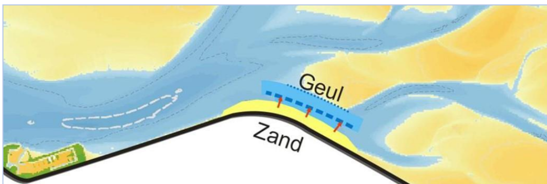
Figuur 4, Variant 'geulwandversterking met zacht materiaal'
