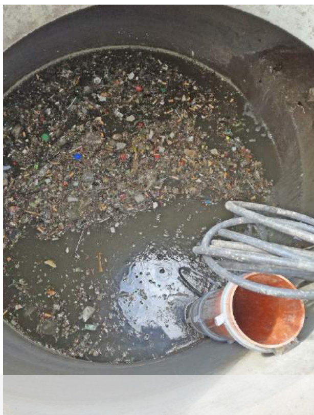
Figuur 36 Vervuilde multiparametersonde Oudsbergen
