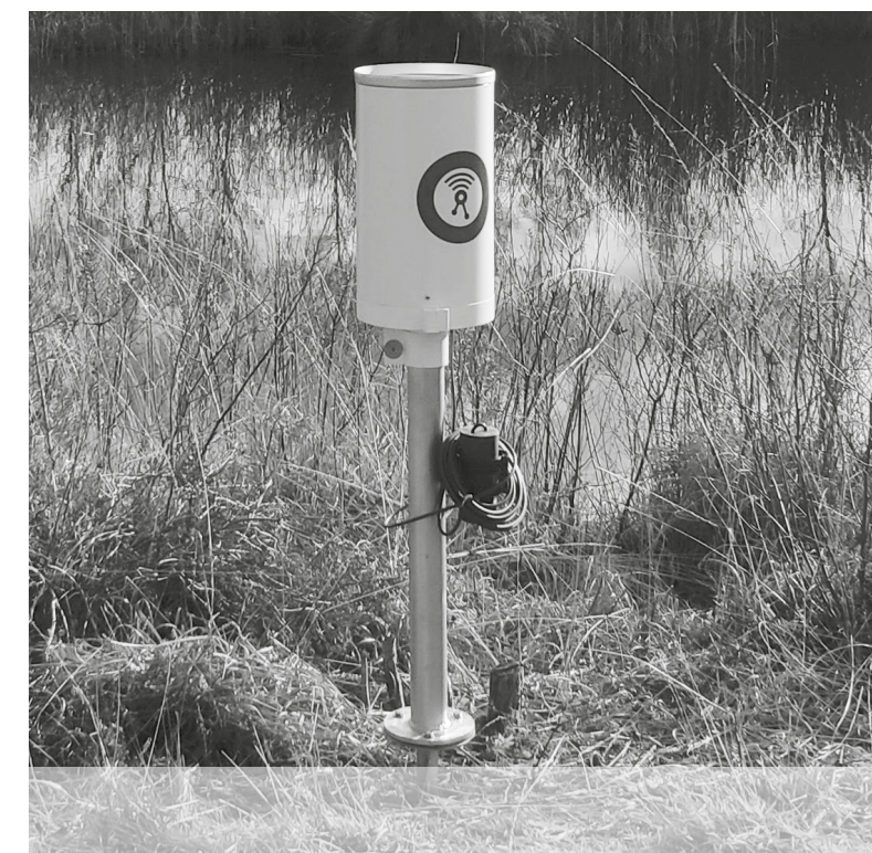
Figuur 6 Voorbeeld opstelling pluviograaf en detail kantelbakmechanisme
