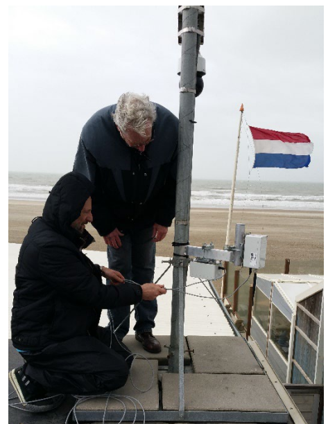
Figuur 3. Sensorbox wordt opgehangen bij een strandtent
