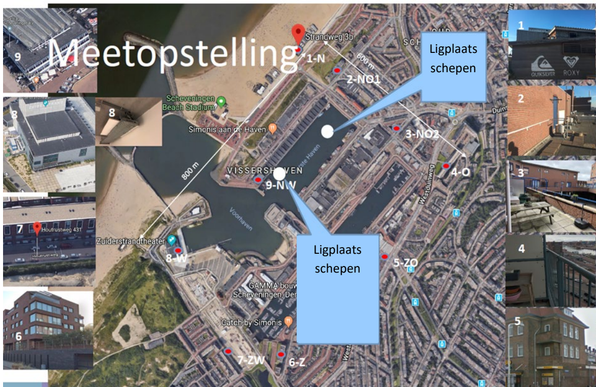
Figuur 4. Meetopstelling met 8 sensoren in verschillende windrichtingen rond de haven van Scheveningen
