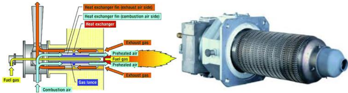
FIGUUR 44 - PRINCIPE VAN RECUPERATIEVE BRANDERS
