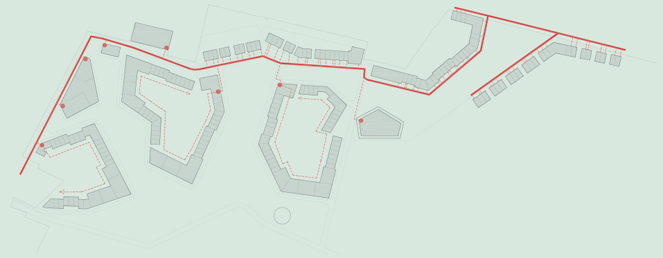
Voltooid project met warmtenet met aansluitingen van centrale stookplaatsen en individuele woningen
