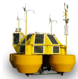
**EOLOS FLOATING SOLUTIONS:** Medición de recurso eólico mediante lidar flotante
