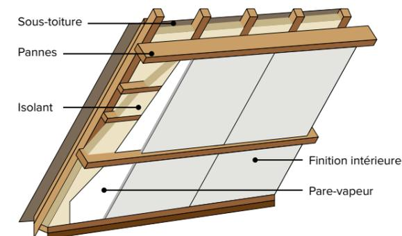
Les combles sont constitués d'une charpente traditionnelle composée de chevrons inclinés et de pannes horizontales. La mise en œuvre consistera à placer une première épaisseur d'isolant entre chevrons, complétée par une seconde couche croisée perpendiculairement afin de satisfaire aux exigences réglementaires.
