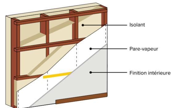
On parle d'une isolation « intégrée » car les panneaux sont posés entre les montants bois en 1 (ou 2) couche(s). En cas de double couche « à joints croisés », il est nécessaire de poser, perpendiculairement aux montants porteurs, une rangée de tasseaux, dont la profondeur sera fonction de l'épaisseur de la seconde couche d'isolant.
