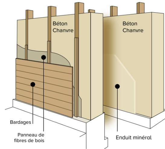
Deux techniques sont possibles : ossature coté extérieur dans le cas d'un bardage, et ossature coté intérieur dans le cas d'un enduit. La projection s'effectue contre le panneau de fibres de bois placée à l'extérieur dans le premier cas, et sur une natte de bambou fendu placé coté intérieur dans le second.
