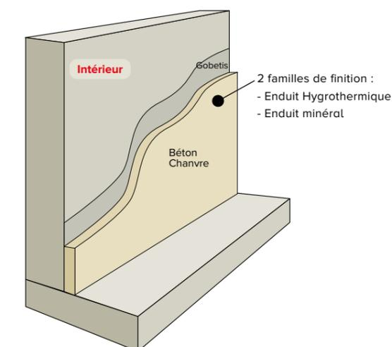
Grâce à un BCC projeté à l'intérieur et recouvert directement d'un enduit, la contre-cloison technique peut être évitée et le confort augmenté. L'inertie intérieure offre une stabilité de température car elle absorbe les pics quand le système de chauffage ou le poêle fonctionne, et restitue la chaleur absorbée quand la source de chaleur s'atténue. La régulation de l'humidité est l'autre point fort du produit.
