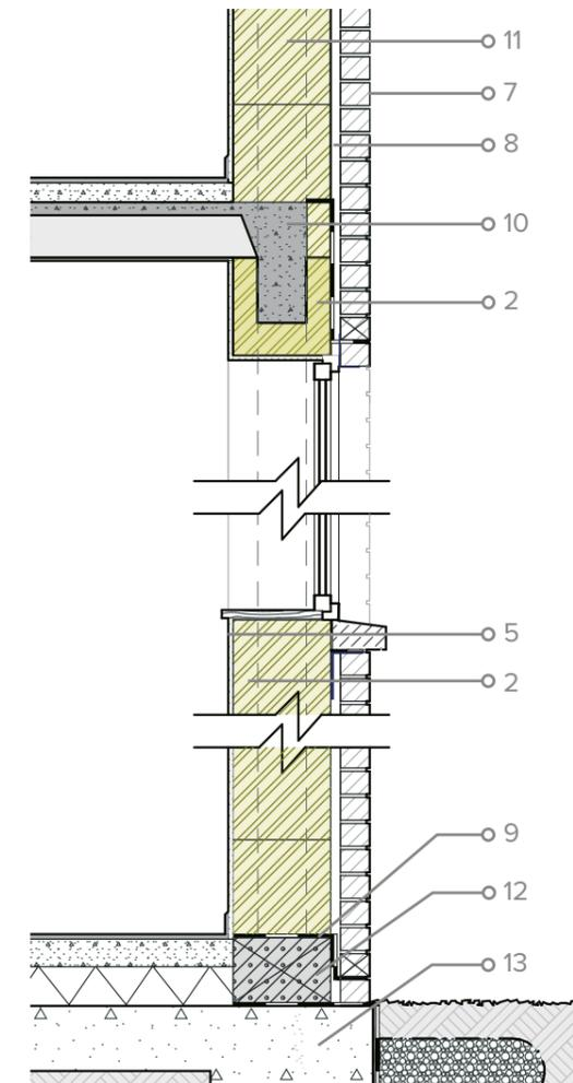
Le système Hempro d'IsoHemp permet de construire l'ensemble du bâtiment uniquement avec des blocs de chanvre.
