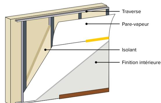
La paroi est composée de pierres maçonnées, de briques, de blocs de béton. L'isolation consistera à doubler la surface intérieure de la paroi en appliquant les panneaux (ou rouleaux) entre les montants verticaux qui serviront de supports pour le parement de finition.
