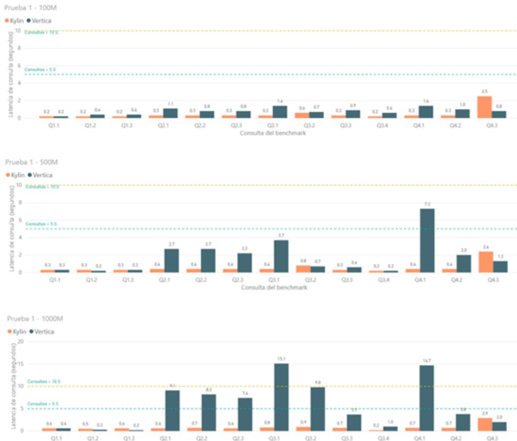
Figura 25. Comparativa entre Kylin y Vertica sobre los tiempos de respuesta sobre distintos volúmenes de datos (I).
