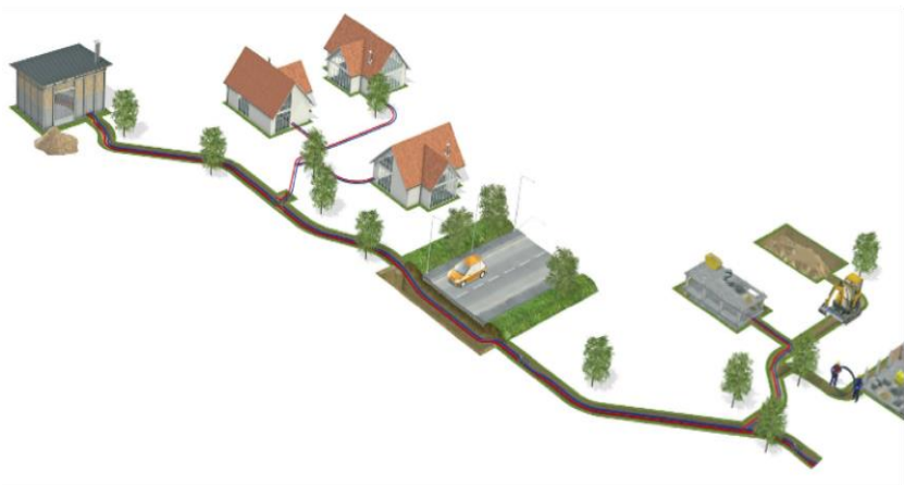
Φωτό 3. Δίκτυο τηλεθέρμανσης κτιρίων με χρήση βιομάζας
