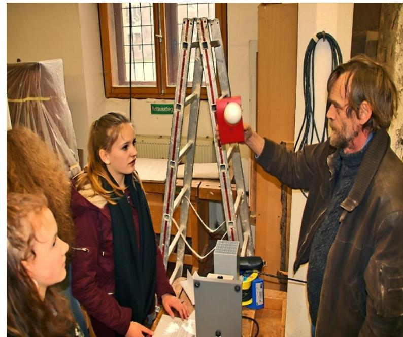
**Durchführung und Erkenntnis:** Das Gebläse stellst du mit der Öffnung nach oben senkrecht auf dem Tisch. Du legst die Styroporkugel in die Mitte des Laminatgitters und schaltest den Luftstromerzeuger an. Langsam erhöhst du den Luftstrom, bis die Kugel ca. 50 cm über der Öffnung schwebt. Auch wenn du das Gebläse schräg hältst, wird die Kugel noch vom Luftstrom getragen. Auch zwei Kugeln können gleichzeitig zum Schweben gebracht werden.
