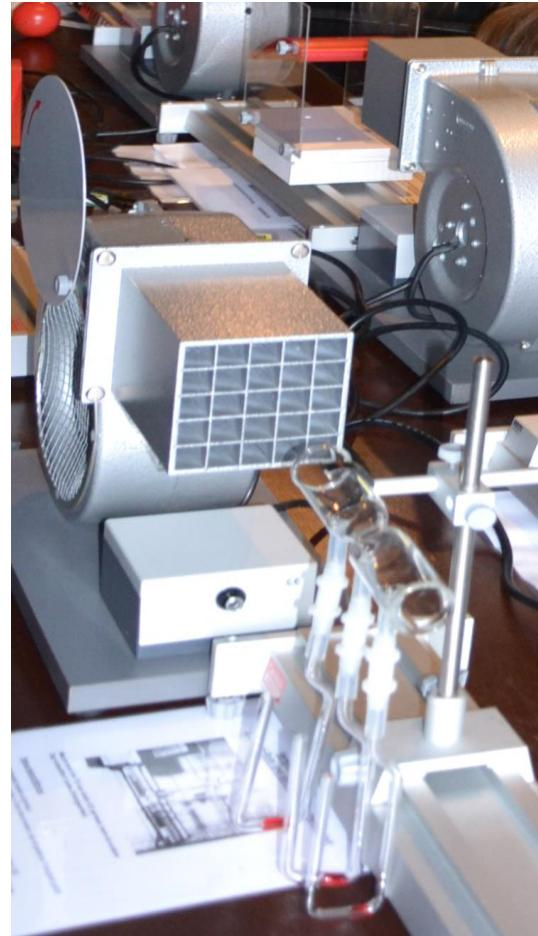
**Erkenntnis:** Der Klappdeckel des LSE wird bis zur maximalen Luftstromerzeugung aufgezogen. Die farbige Flüssigkeit in den drei U-Rohren wird unterschiedlich zum Venturirohr hochgezogen. Am stärksten ist der Luftsog im Mittelstück des Venturirohrs. Dort ist das Rohr am schmalsten.
