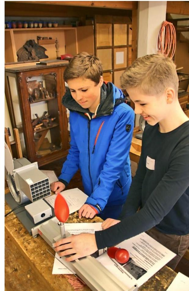
**Erkenntnis:** Von allen Körpern beeinflusst die Tropfenform als Stromlinienkörper die Fäden des Kamms am wenigsten. Die Fäden liegen am Körper an (laminar) und wirbeln nicht chaotisch in der Luft (turbulent). Deshalb ist diese Form am aerodynamischsten und hat den geringsten Luftwiderstand.
