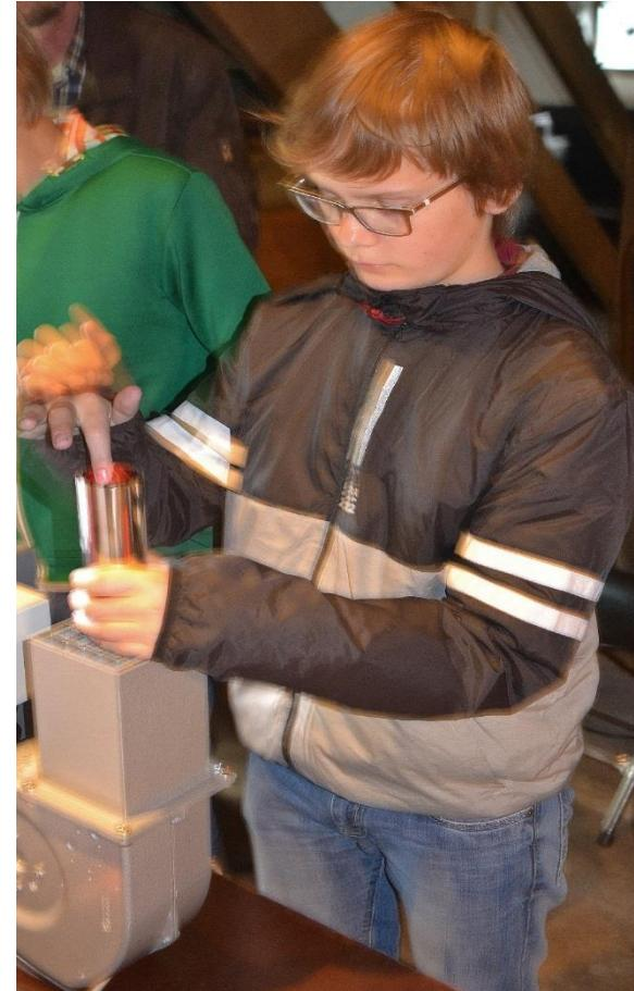
**Erkenntnis: die Kugel verringert im Rohr den Durchmesser. Dadurch steigt um die Kugel herum im Rohr die Strömungsgeschwindigkeit. Der beschleunigte Luftstrom lässt die Kugel durch das Rohr sausen (Bsp.: Wassertunnelrutsche – der rutschende Körper beschleunigt, wenn der Tunnel enger wird).**
