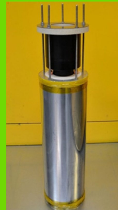
Figuur 2: Exergy upscaled prototype cel. (24 van deze cellen vormen een batterij met ca. 5 kWh capaciteit.)
