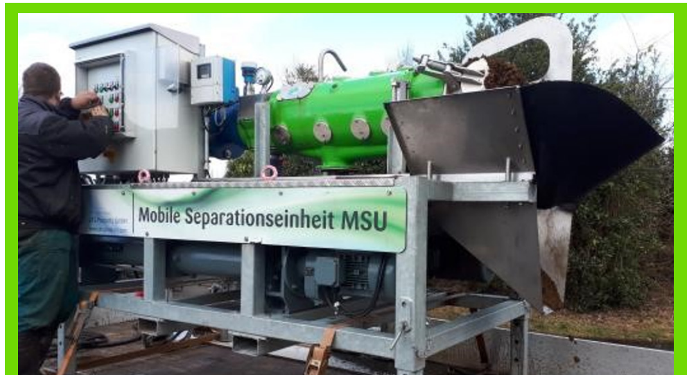
Testrun van de drukloze scheiding op een biogasinstallatie in het Emsland
