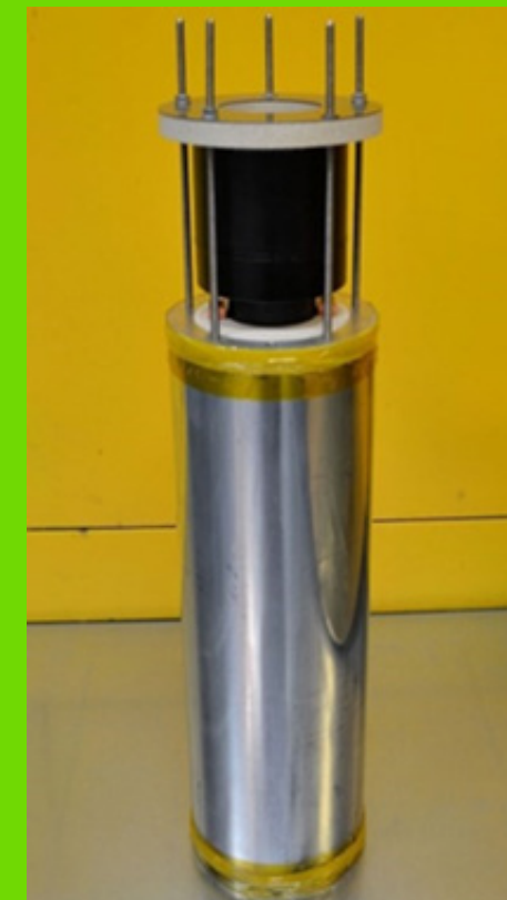
Abbildung 2: Exergy hochskalierte Prototypzelle. (24 dieser Zellen bilden eine Gen1-Batterie mit einer Kapazität von ca. 5 kWh.)
