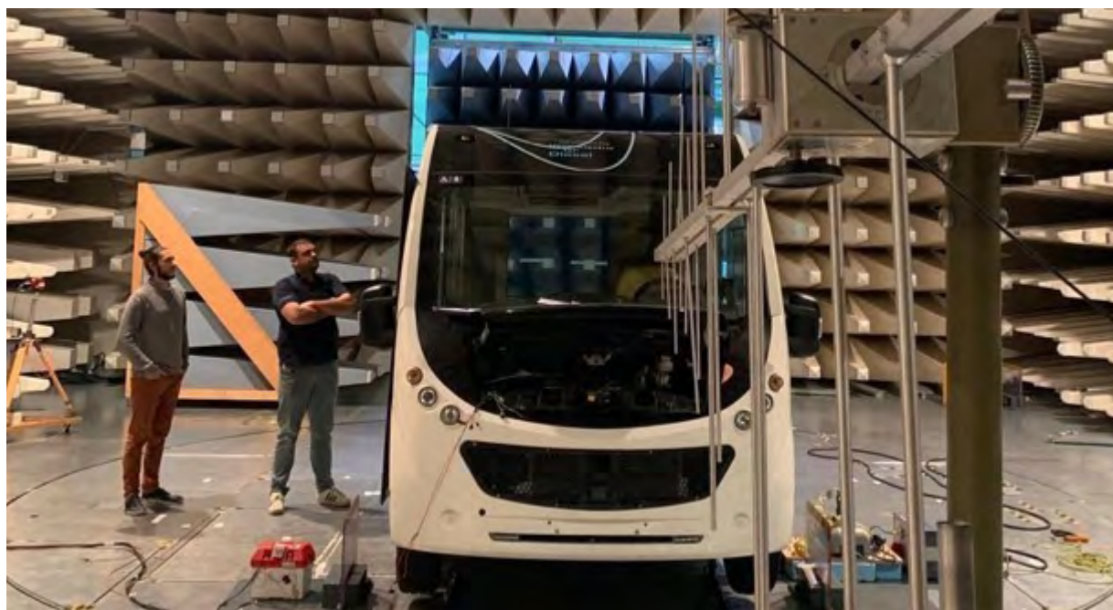
Figuur 3.10: Mission bus van Urban Mobility Systems ondergaat EMC testen; Bron: urbanmobilitysystems.nl
