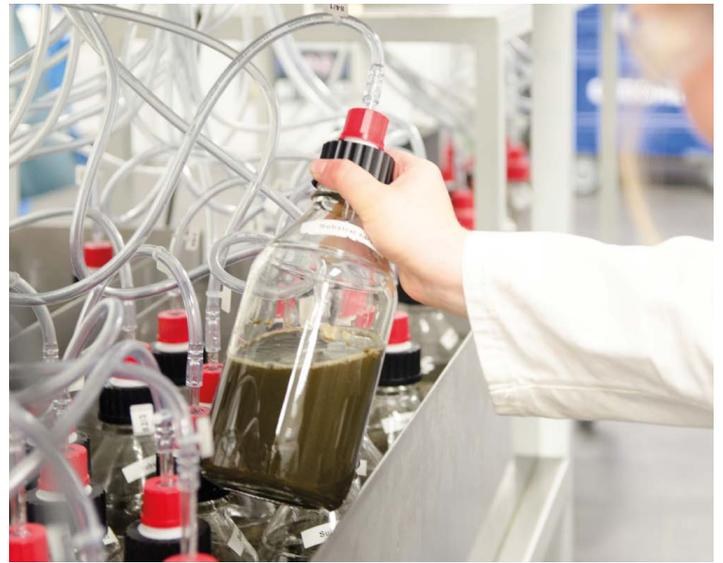
Abbildung 2: Versuchsstand zur Untersuchung des Gaspotentials mit Batch-Gärtests
