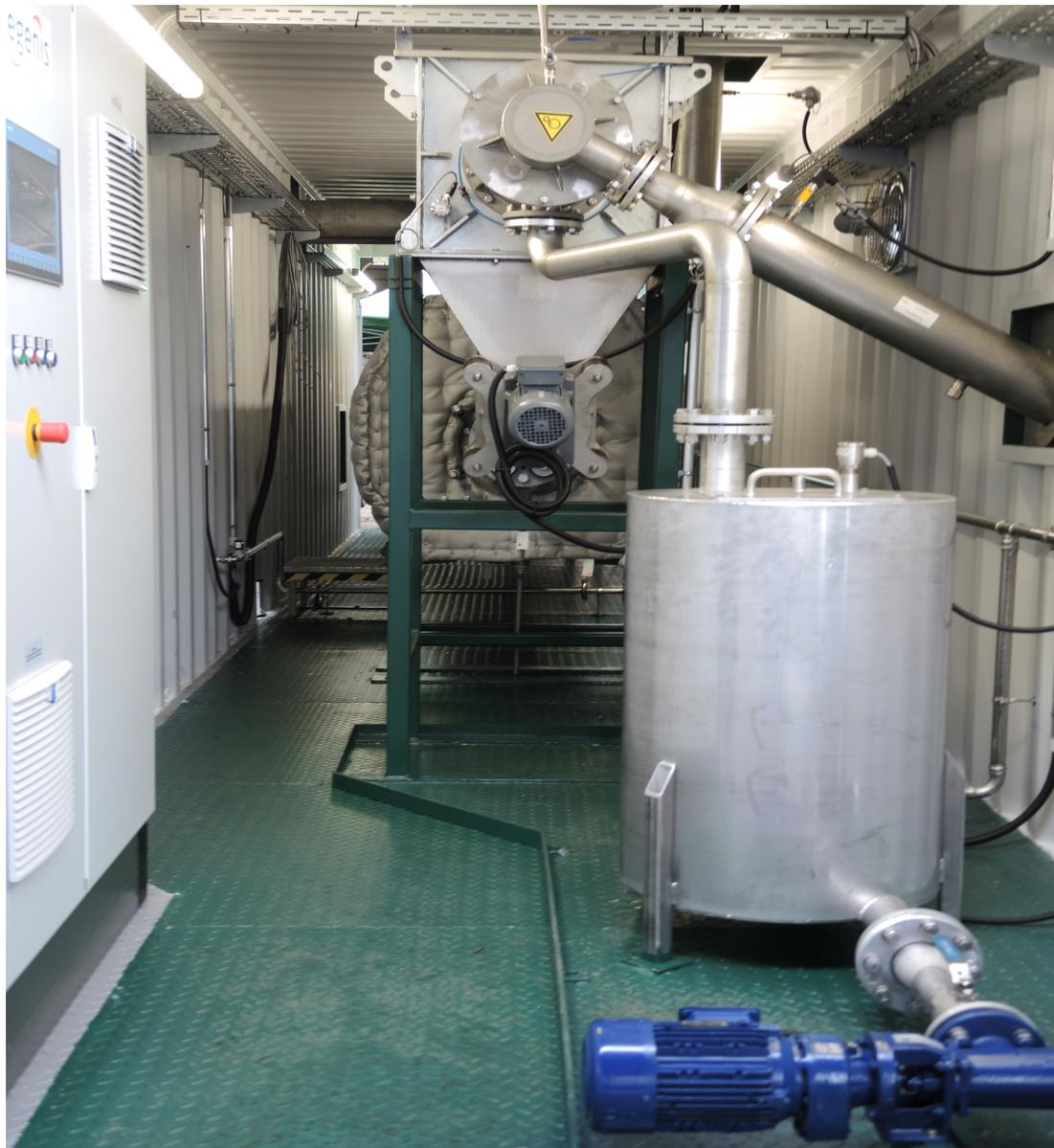
Ca. 100 Referenzanlagen zeigen dass ein Separator im Dauerbetrieb hohe Abscheideleistungen erreichen kann
