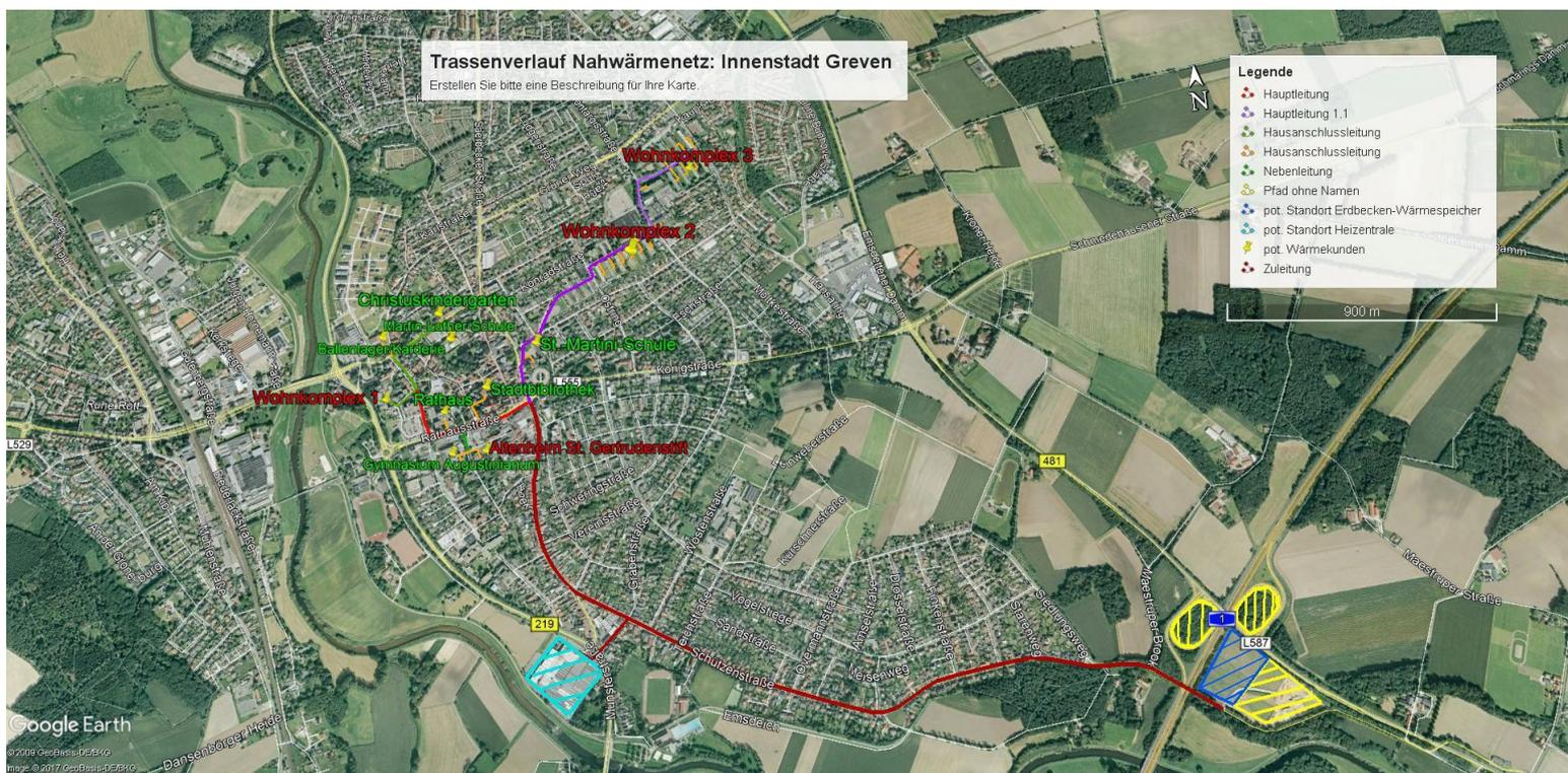
Abbildung 10: Vortrassierung des Nahwärmenetzes Innenstadt mit Zuleitung, Haupt- und Nebenleitungen sowie den potentiellen Standorten für das Biomethan-BHKW, den Wärmespeicher und das Solarkollektorfeld [ (© 2017 Google Earth Pro, 2017), bearbeitet]
