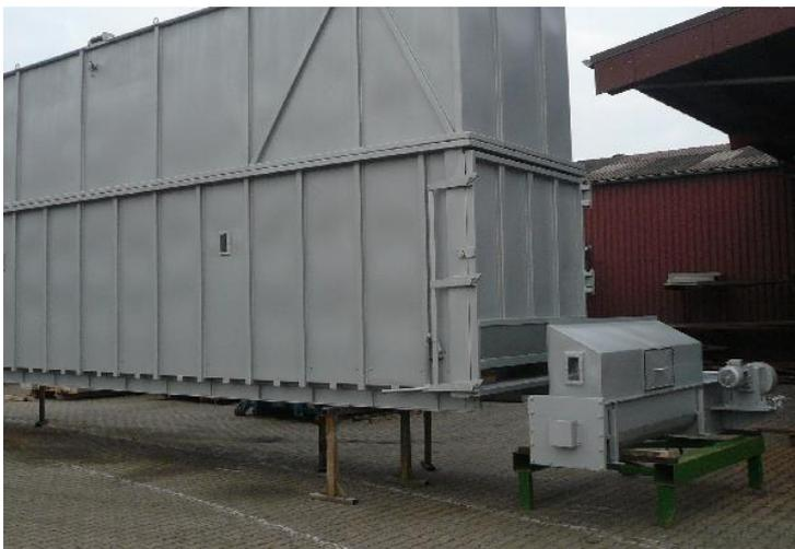
Abbildung 16: Beispiel eines Schubbodencontainers mit Austragsystem
