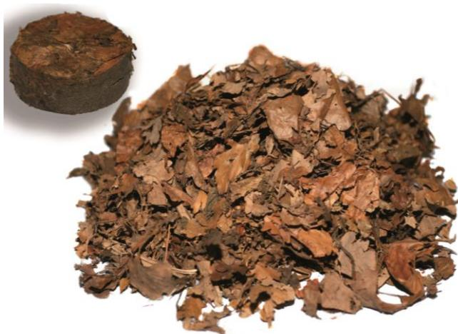
**Abbildung 6: Getrocknetes Laub in loser und brikettierter Form**
