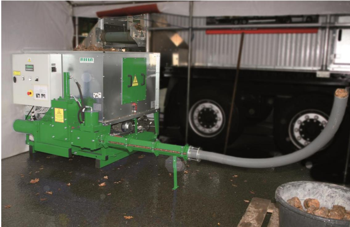
**Abbildung 23: Brikettiermaschine in Verbindung mit einem mobilen Laubtrockner**
