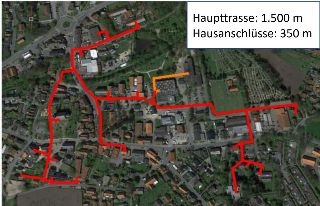
Abbildung 3: Lageplan mit den möglichen Trassenverläufen des Wärmenetzes
