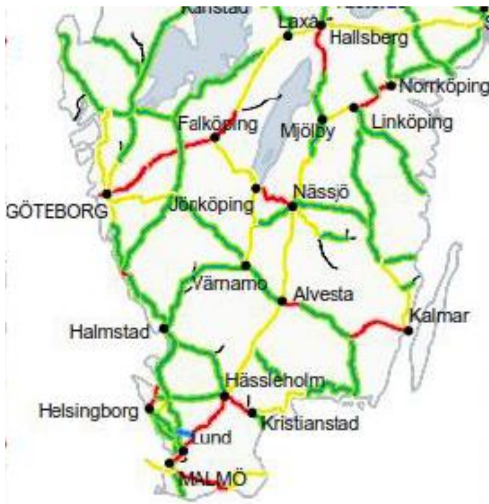
Figur 49 Kapacitetsutnyttjande på järnväg 2016, vardagsmedeldygn. Fullt utnyttjade sträckor är markerat med rött. Sträckor med gott om ledig kapacitet är markerat med grönt. (Källa: Trafikverket 2017:062)
