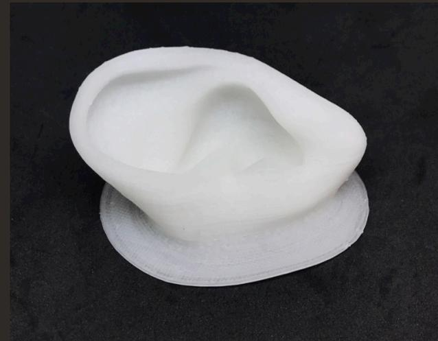
La technologie Pam permet de traiter des matériaux à haute flexibilité, contrairement aux procédés classiques FDM, SLS et SLA. Cette pièce présente un excellent aspect de surface, une bonne adhésion inter-couches.
